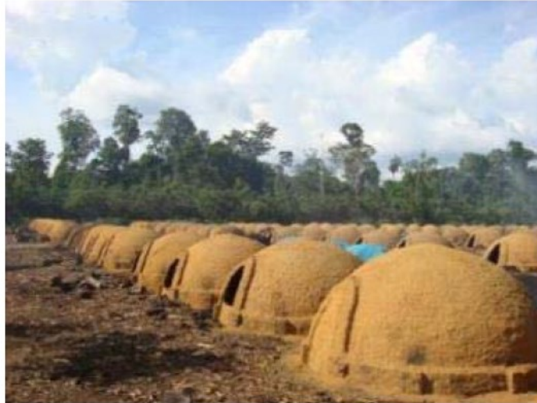
Figura 2.4 – Forno do tipo Rabo Quente (Almado, 2014)
