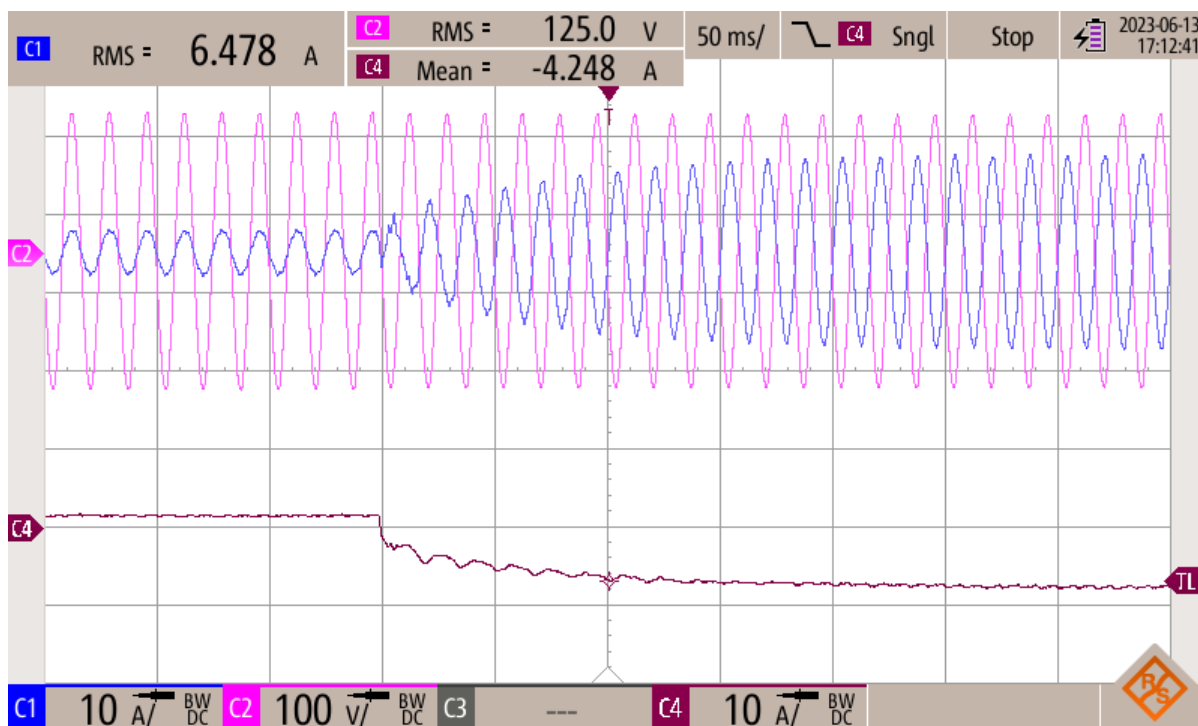
Figura 69 – Tensões e Corrente CA - Variação negativa controle.
