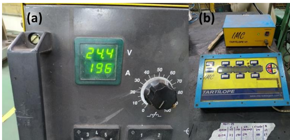
Figura 14 – Equipamentos utilizados no processo de soldagem. (a) Indicador de corrente e tensão da máquina de solda; (b) Teclado remoto do controlador de deslocamento Tartílope V1.
