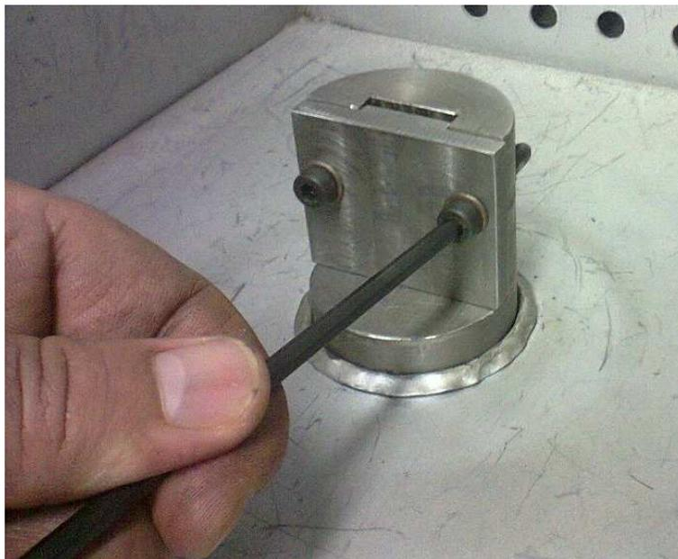
**Figura 5.2:** Aperto dos Parafusos em Laboratório
