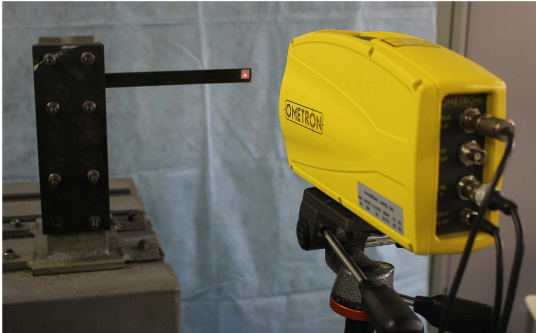
**Figura 5.11:** Vibrômetro Laser - OMETRON
