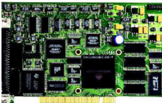
**Figura B.3:** Placa para Aquisição de sinais Dspace
