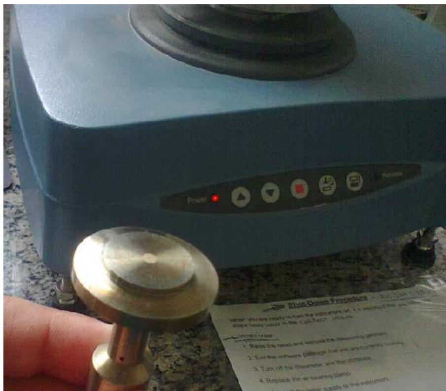
**Figura 5.9:** Geometria Utilizada no Reômetro
