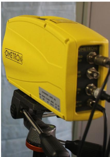
**Figura B.2:** Vibrômetro Laser
