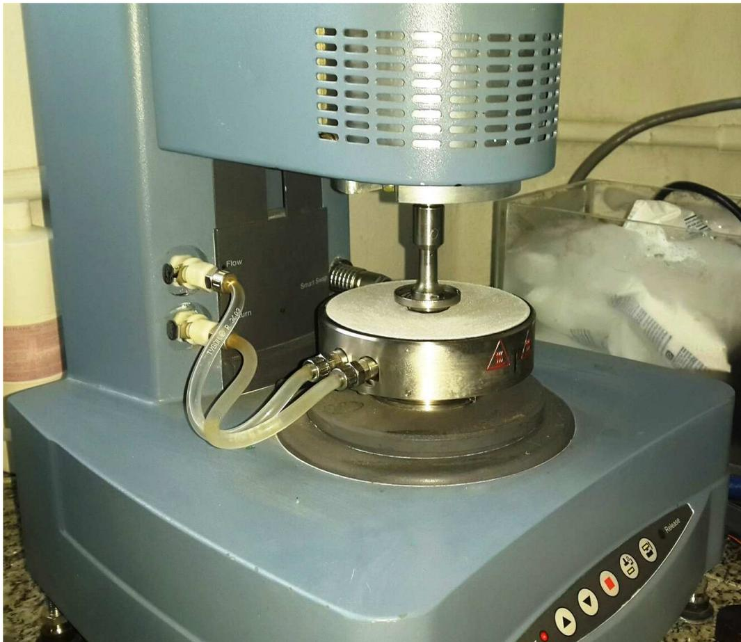
**Figura 5.8:** Ensaio com Variação de Temperatura e Frequência no Reômetro
