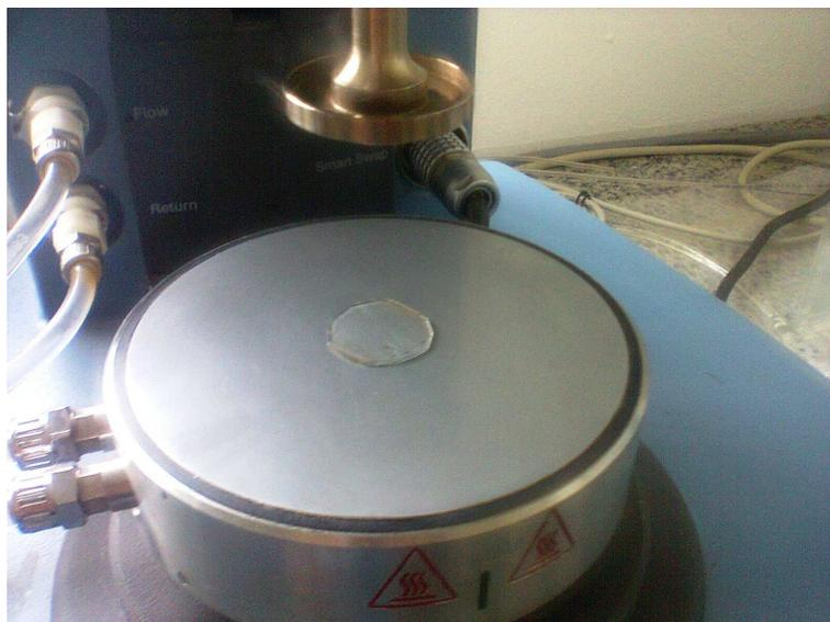
**Figura B.5:** Reômetro modelo AR2000 -TA Instruments
