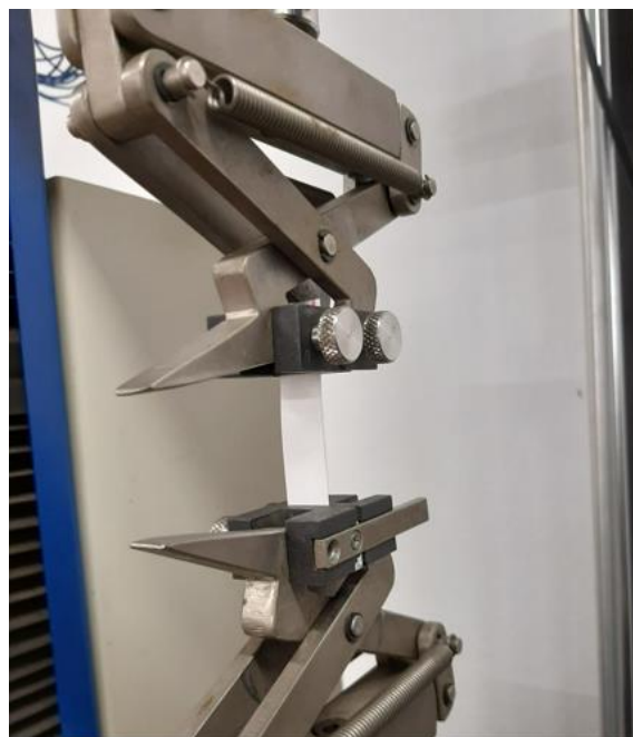
Figura 42 - Imagem do posicionamento da amostra no equipamento de tração - vista detalhada
