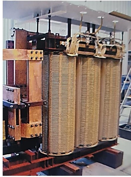
Figura 15 – Imagem de Bobina com papel isolante novo
