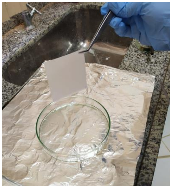
Figura 366 - Imagem da preparação da amostra por Dip Coating a base de PVDF
