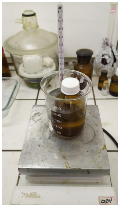
Figura 355 - Imagem da preparação da solução de PVDF
