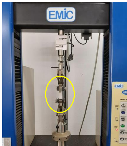
Figura 41 - Imagem do posicionamento da amostra no equipamento de tração
