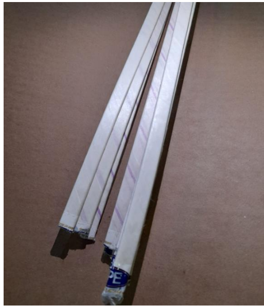
Figura 10 – Imagem de fitas de cobre envolto de papel dielétrico
