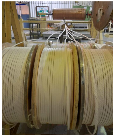
Figura 9 – Imagem de um carretel de cobre envolto com papel dielétrico - vista geral
