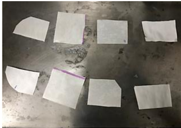
Figura 39 - Imagem dos corpos de prova para ensaio de umidade
