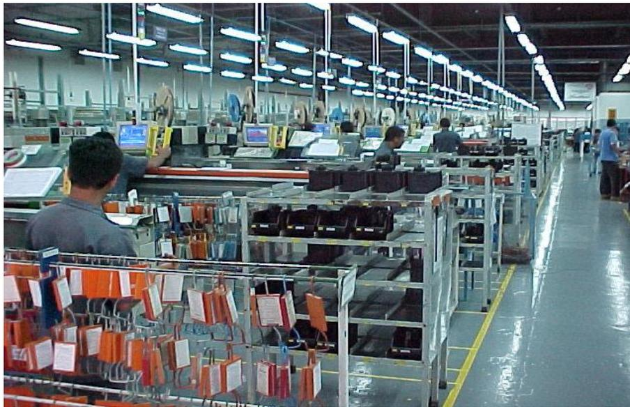
**Figura 4.7** Vista do arranjo-físico anterior referente a área de máquinas de corte que mostra o processo produtivo departamentalizado.
