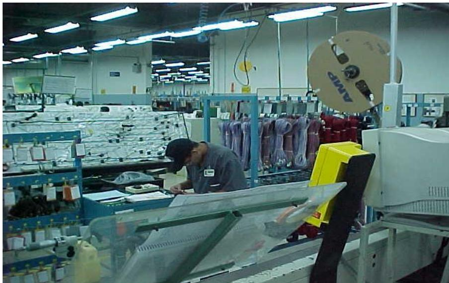
**Figura 4.8** Vista do arranjo-físico atual que mostra a máquina de corte dedicada à linha de produção.
