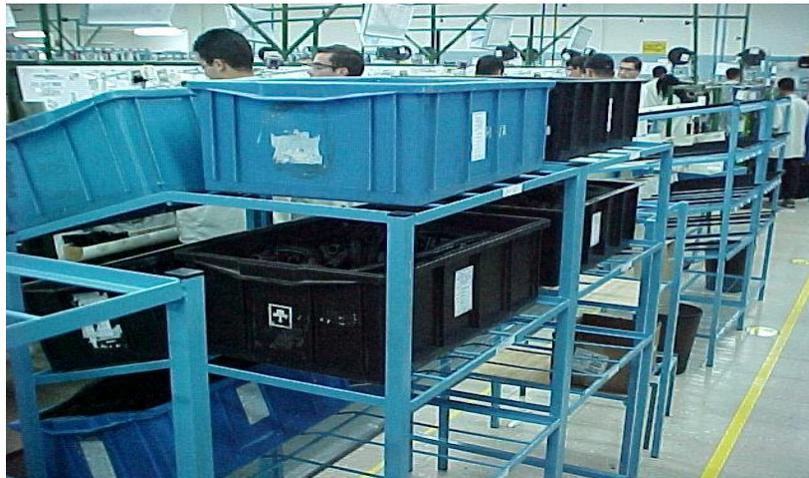
**Figura 4.12** Exemplo de supermercado na linha produtiva que mostra um corredor de alimentação e outro corredor de ponto de uso.
