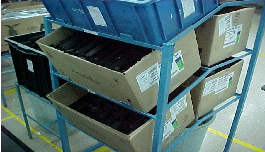
**Figura 4.11** Exemplo mostra a embalagem do fornecedor na linha de produção para evitar operações de transbordo.
