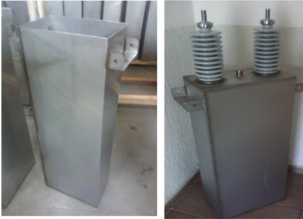
Figura 21 – Tanque de Capacitor
