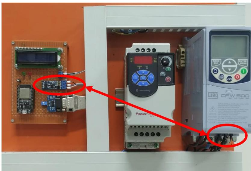
Figura 14: *TTL to RS485 module - C25B* conectado ao inversor de frequência e ao ESP32.
