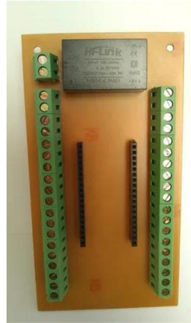
Figura 68 – Placa socket do microcontrolador
