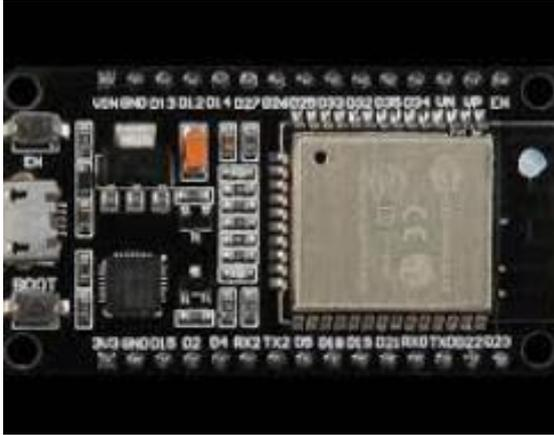
Figura 67 – Microcontrolador *ESP32*
