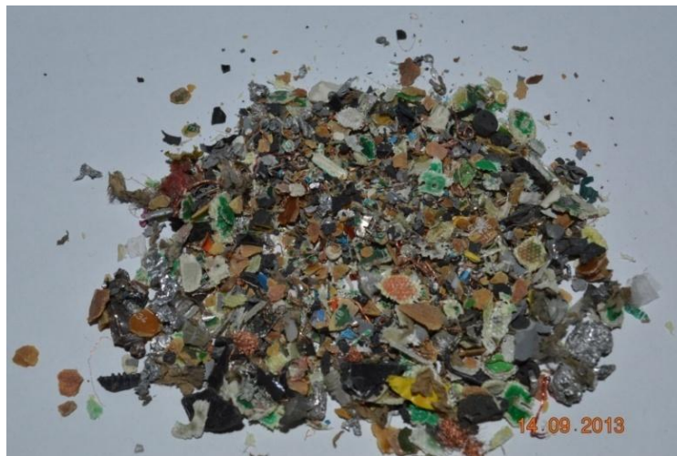
Figura 3.5 - Resíduos de placas de circuito impresso após processo de moagem em moinho de martelos – Fração pesada - Primeiro ajuste – peneira grossa – malha \Phi = 16 mm.
