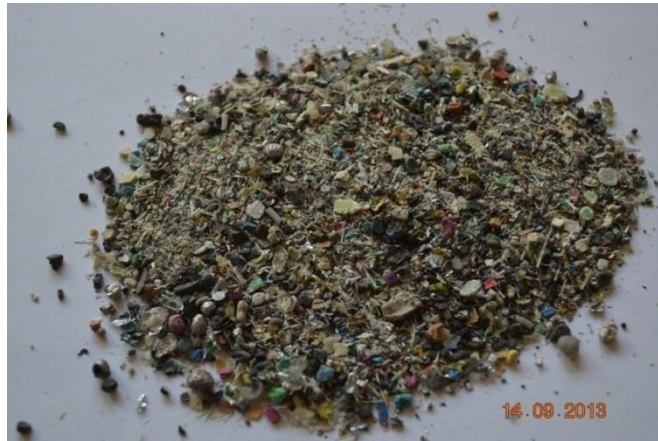
Figura 3.6- Resíduos de placas de circuito impresso após processo de moagem em moinho de martelos – Fração pesada - Segundo ajuste – peneira fina - malha \Phi = 9 mm.
