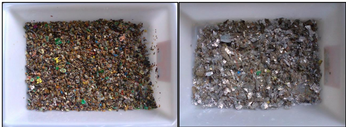
Figura 3.10 - Amostras utilizadas: Fração pesada (esquerda) e fração leve (direita)
