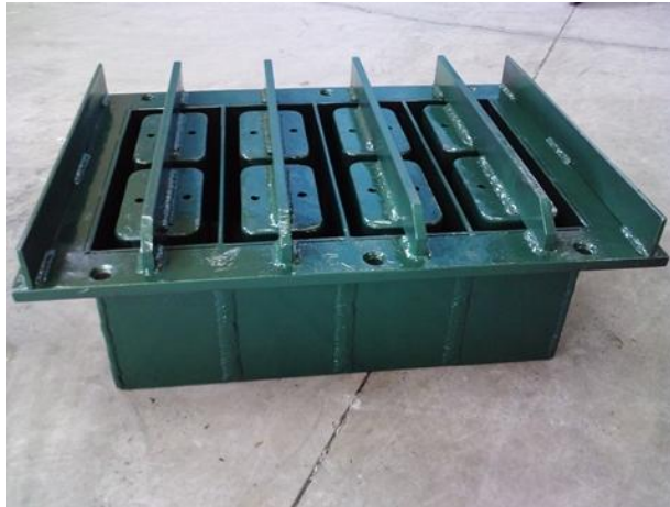
Figura 2.14 - Molde para blocos de concreto. Fonte: Montbloc Formas e Moldes para Bloco e Piso de Concreto. Fonte: ( www.montbloc.com.br )
