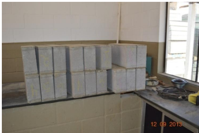
Figura 3.15- Blocos preparados para ensaios de compressão através do capeamento com pasta de cimento nas duas faces de assentamento.
