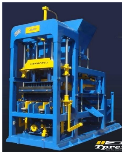
Figura 3.8 - Prensa vibratória hidráulica para a fabricação dos blocos Fonte: www.tpex.com.br
