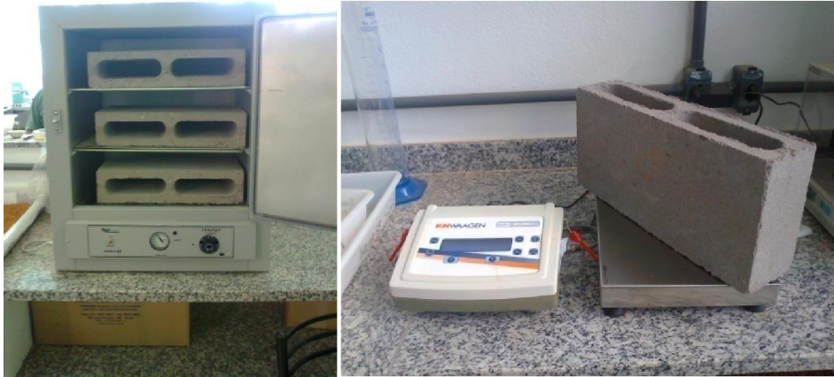
Figura 3.13 - Secagem dos blocos em estufa (esq.) e pesagem (dir.).
