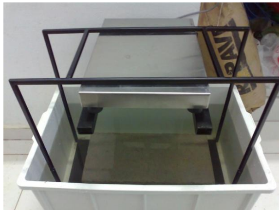
Figura 3.14 -Medição da massa aparente com o bloco imerso em água, estando a balança suspensa em suporte e com prato mergulhado no tanque, em montagem hidrostática.
