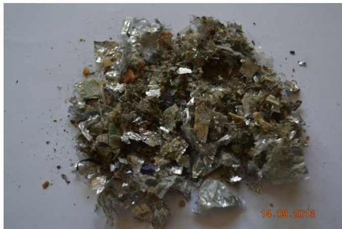
Figura 3.7 - Fração leve dos resíduos de placas de circuito impresso após moagem em moinho de martelos. Observa-se fragmentos de folhas aluminizadas, que são oriundas dos capacitores eletrolíticos e o material proveniente do substrato de fibra de vidro.
