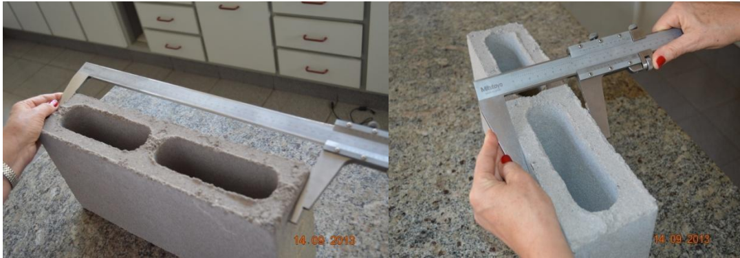
Figura 3.12 - Medição das dimensões externas dos blocos
