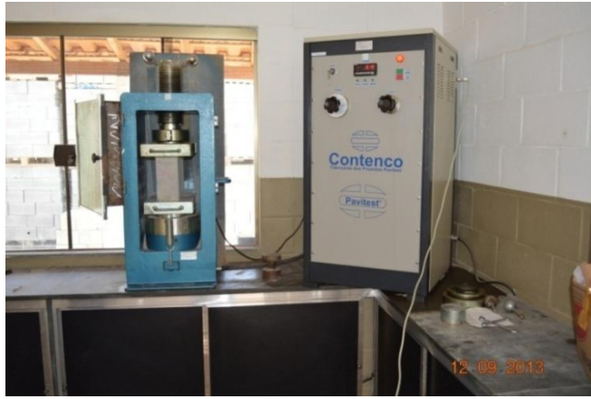
Figura 3.16 - Prensagem do bloco em prensa hidráulica com controle da taxa de crescimento da força aplicada.
