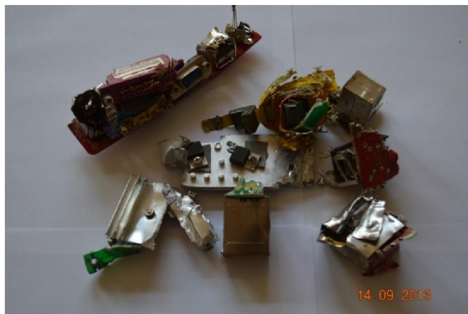
Figura 3.4 - Fragmentos separados após o processo de trituração por conterem partes metálicas em alumínio, ferro, ferrite e fios de cobre de maiores dimensões e/ou peso.
