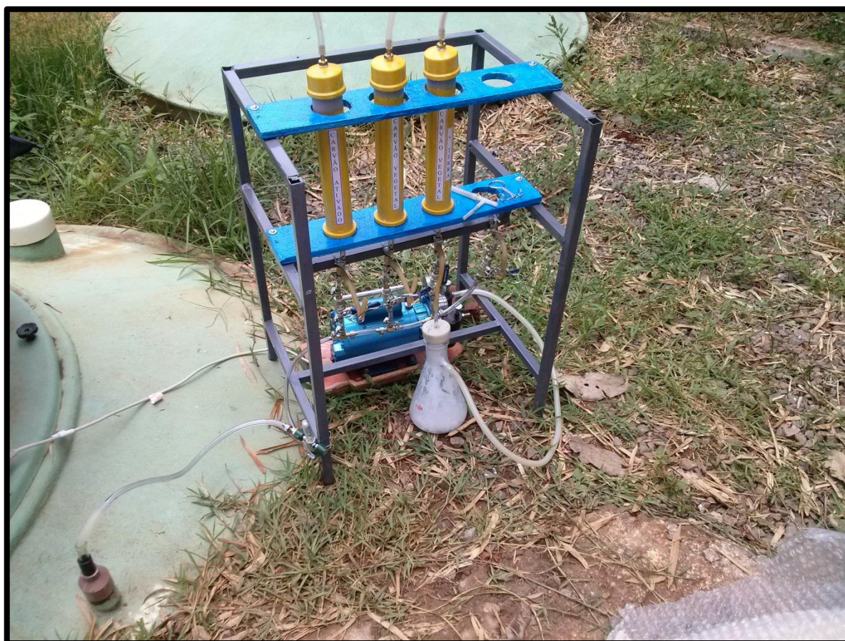
Figura 15 - Filtros para tratamento do sulfeto de hidrogênio durante análise de sulfeto de hidrogênio.
