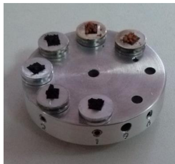
Figura 50 - Suporte onde foram colados os materiais para em seguida passar pelo processo de metalização. Fonte: arquivo pessoal.
