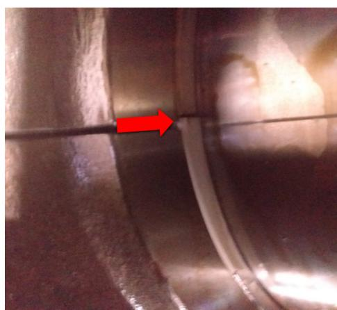
Figura 89 – Deslocamento do cilindro B7.
