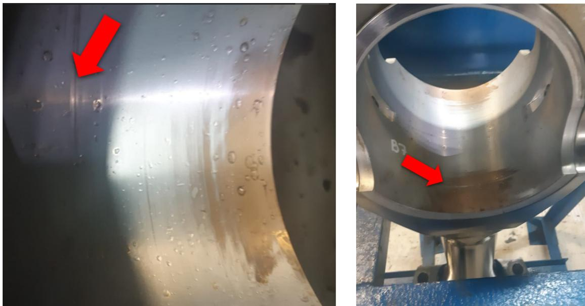
Figura 92 – Bucha da biela com defeito devido a decorrência da limalha.
