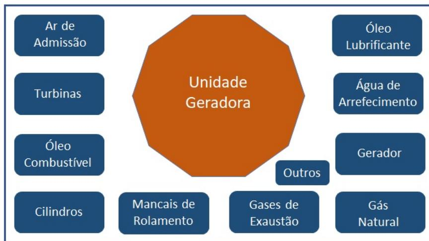
Figura 27 – Diagrama da unidade geradora dividida em 11 subsistemas.
