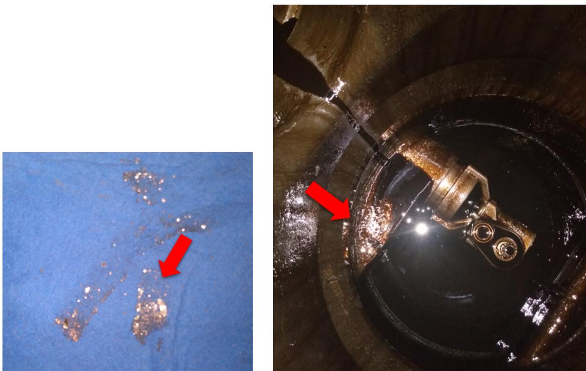
Figura 93 – Presença de limalha no alojamento do filtro automático de óleo lubrificante.
