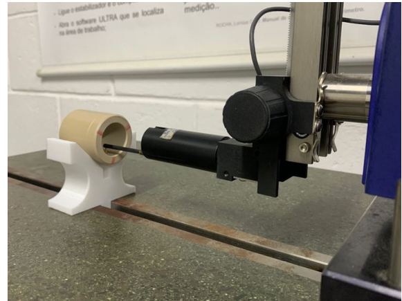
Figura 21 – Set up para a medição de circularidade e rugosidade
