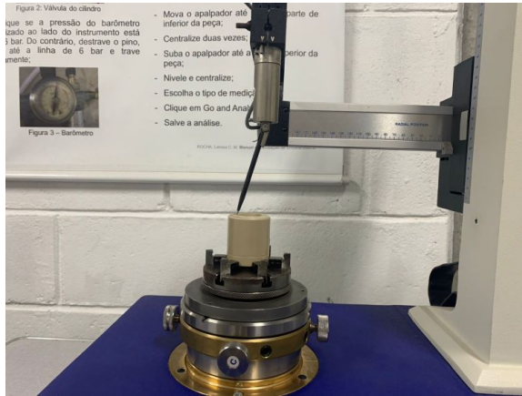
Figura 21 – Set up para a medição de circularidade e rugosidade
