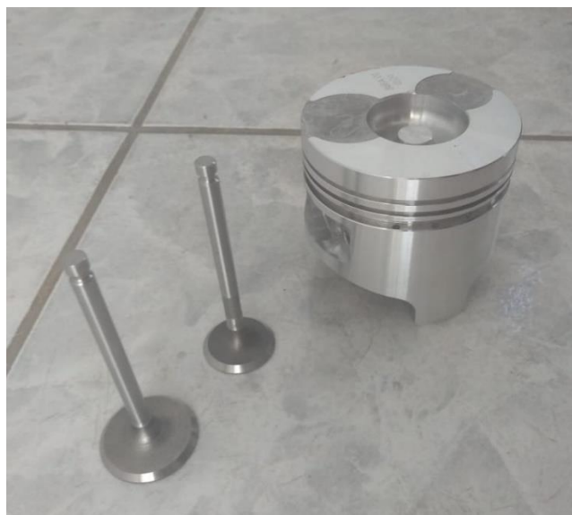
Figura 22: pistão e válvulas do motor Buffalo BDFE 10.0.
