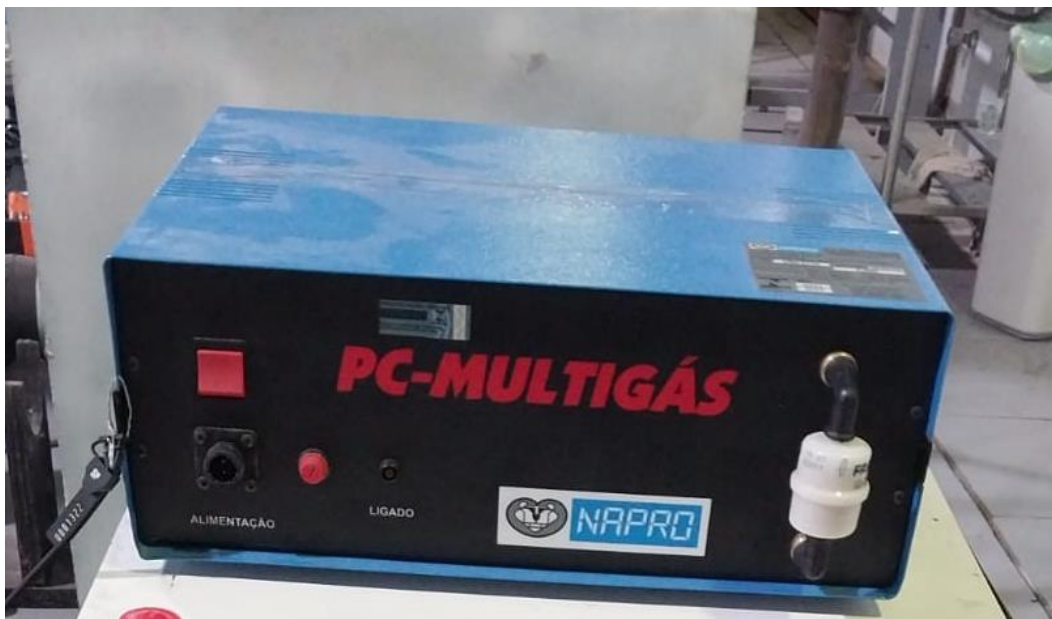
Figura 10: analisador de gases PC Multigás.
