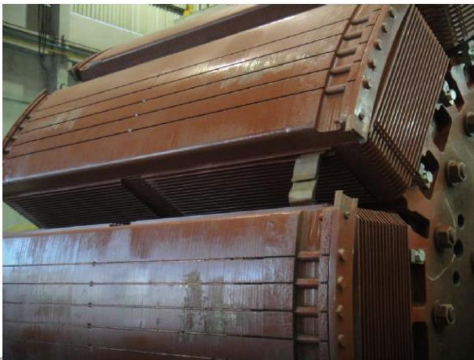
*Figura 2-13 - Núcleo dos polos*
