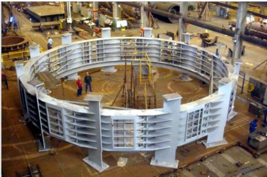
Figura 2-4 - Carcaça do estator
