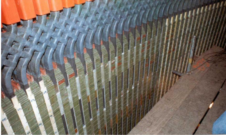
Figura 2-8 - Enrolamento do estator com Barras Roebel
