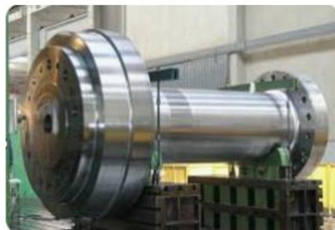
(b) eixo inferior do gerador com o bloco de escora e flange para acoplamento com eixo da turbina
