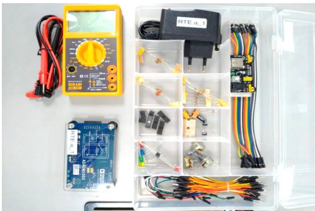
Figura 1 - Kit de atividades práticas de laboratório utilizado nas disciplinas ELTA10 e ELTA10A durante o ER.
