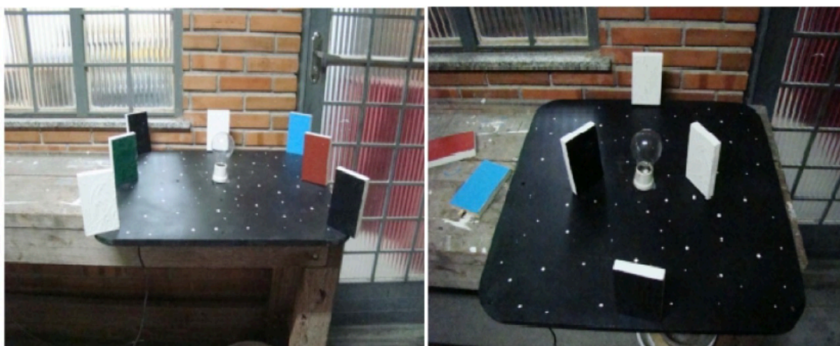
Figura 1. Experimento de absorção de calor por diferentes cores.
