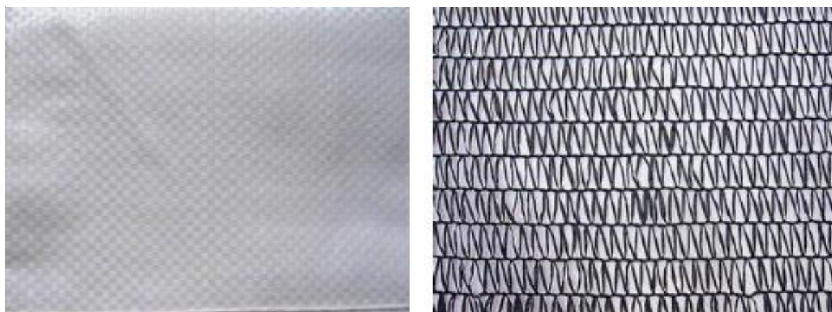
Figura 46: Sacaria de Polipropileno Tecido (PP-T) e sacaria em malha raschel (PEAD-MR).
