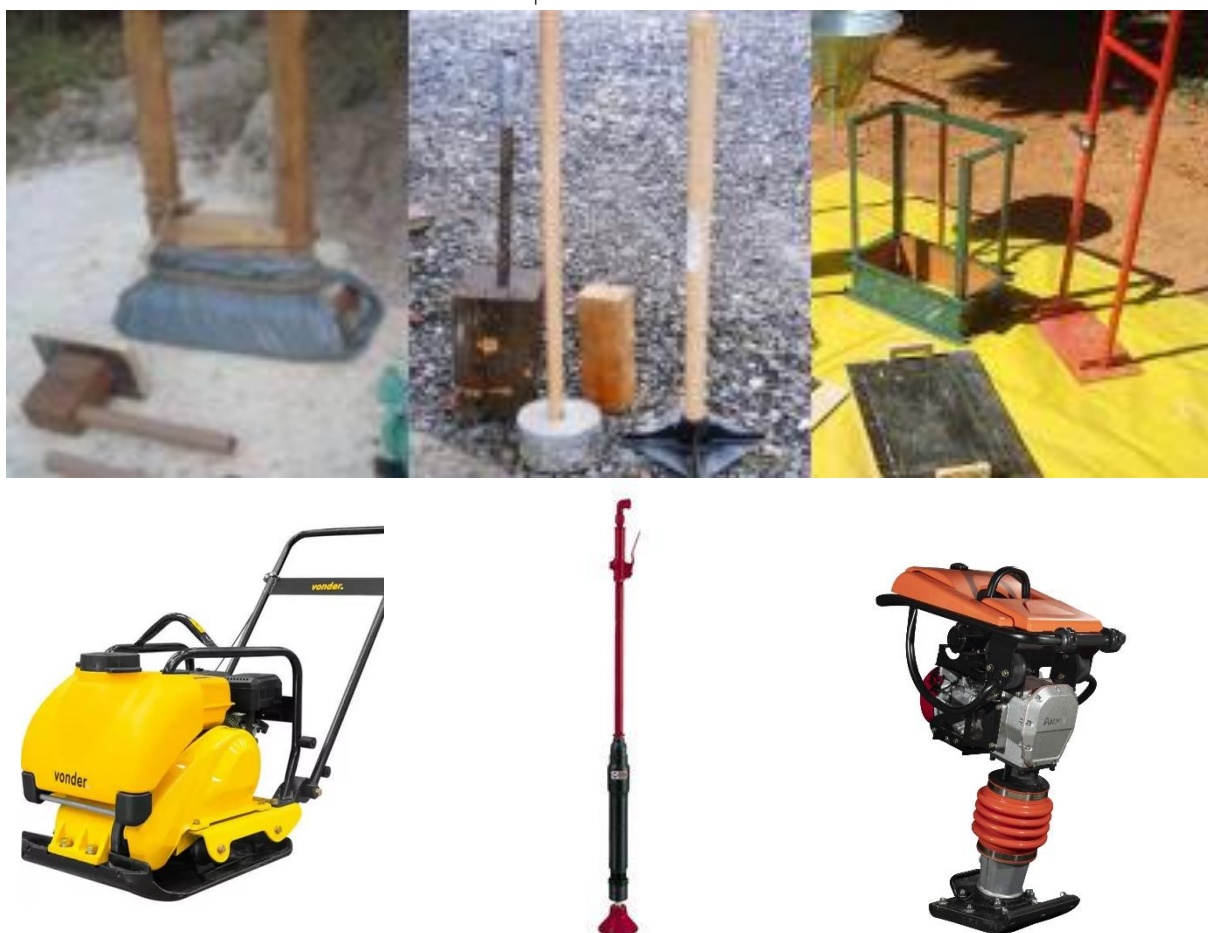
Figura 50: Exemplos de compactadores utilizados em obras de CTE: Superiores – pilão manual; Inferiores – compactador mecânico.
