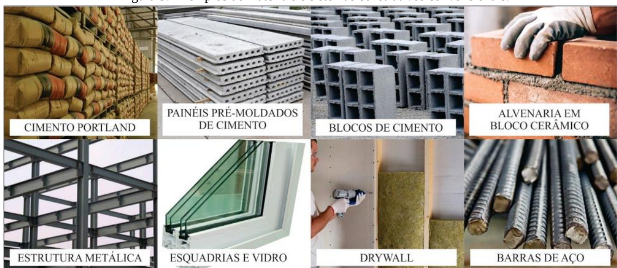
Figura 5: Exemplos de materiais e sistemas construtivos convencionais.
