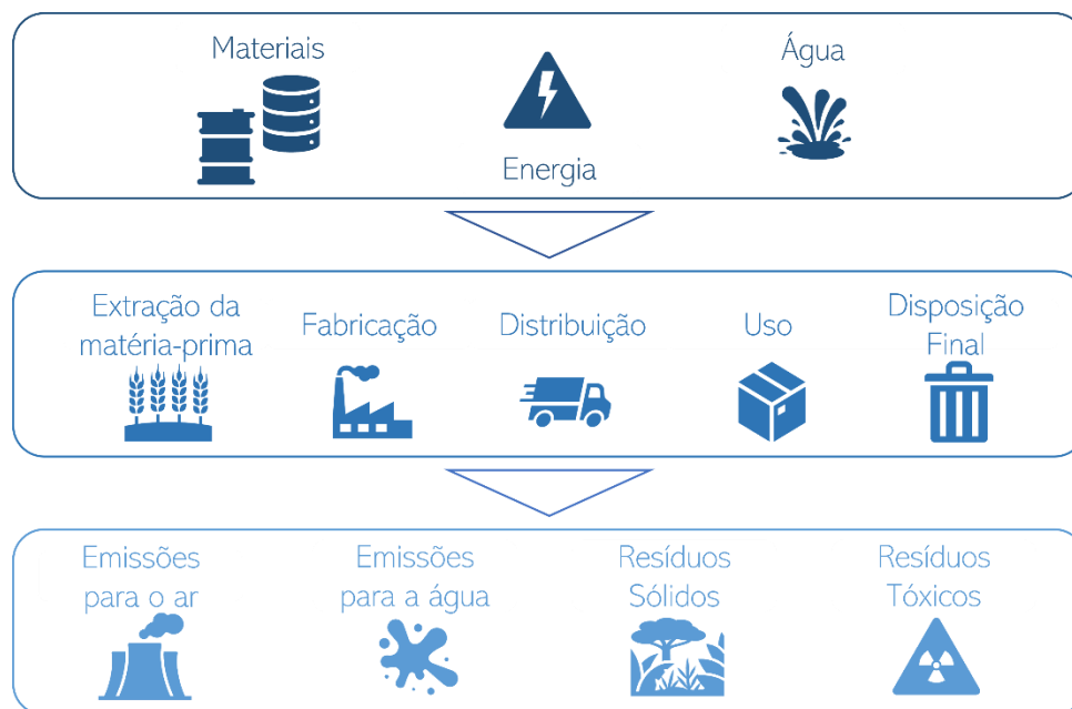
Figura 6: Representação das etapas consideradas em um estudo de ACV. Fonte: (MOURAD et al., 2007)
