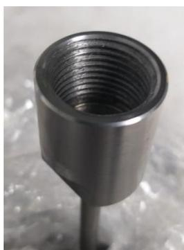
Figura 11 - Terminação do tubo para fixação do adaptador Thompson.
