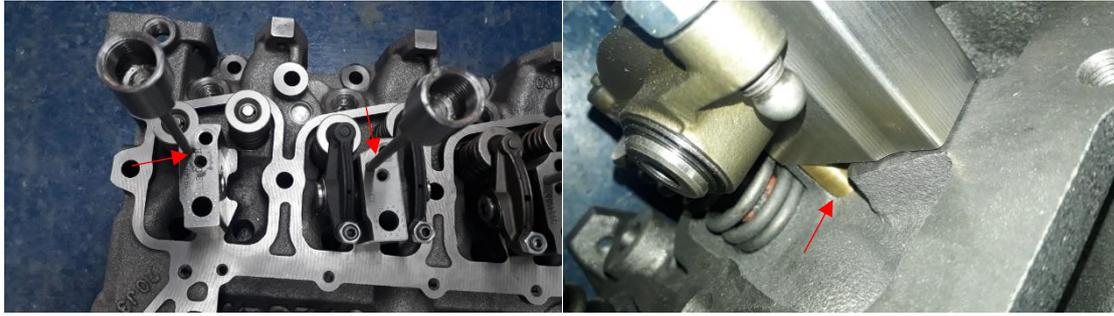
Figura 12 - Detalhes do tubo de tomada de pressão e vedações.
