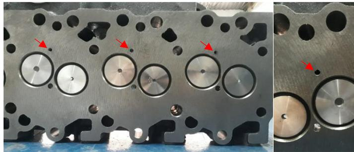
Figura 13 - Detalhes do furo adicional no cabeçote para acesso à câmara de combustão.
