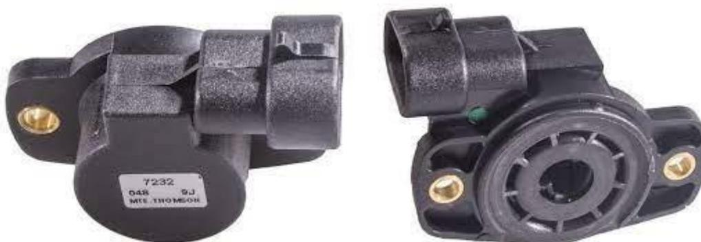
Figura 34 - Imagens do sensor de posição angular utilizado.
