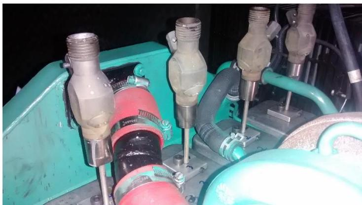
Figura 16 - Mangueira de entrada de ar no Intercooler ajustada.
