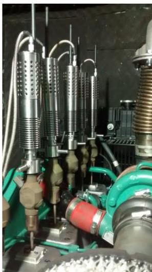
Figura 38 - Sensores de pressão intracilindro instalados no laboratório de modelo reduzido.
