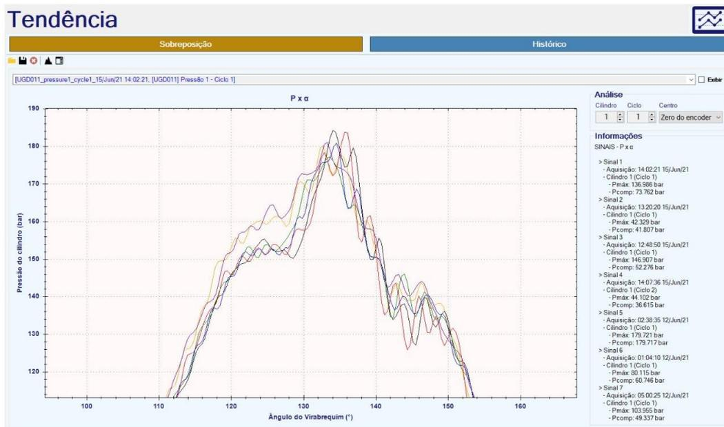
Figura 53 - Curva de pressão intracilindro obtida para várias condições de operação.
