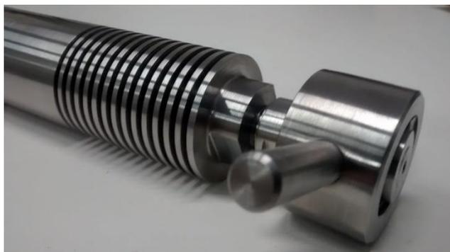
Figura 28 - Gabinete do sensor de pressão intracilindro desenvolvido.
