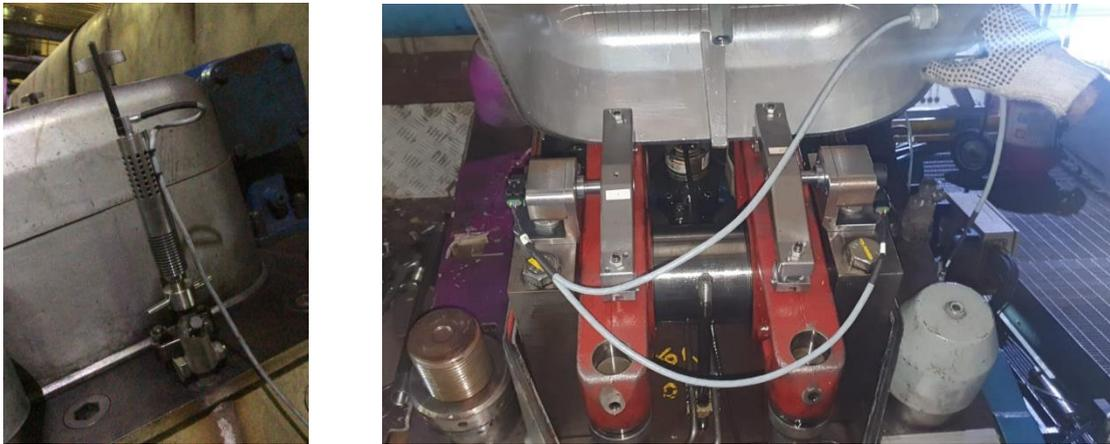
Figura 50 - Sensores de pressão intracilindro e posição das válvulas no motor 18V46 na UTE Raesa.
