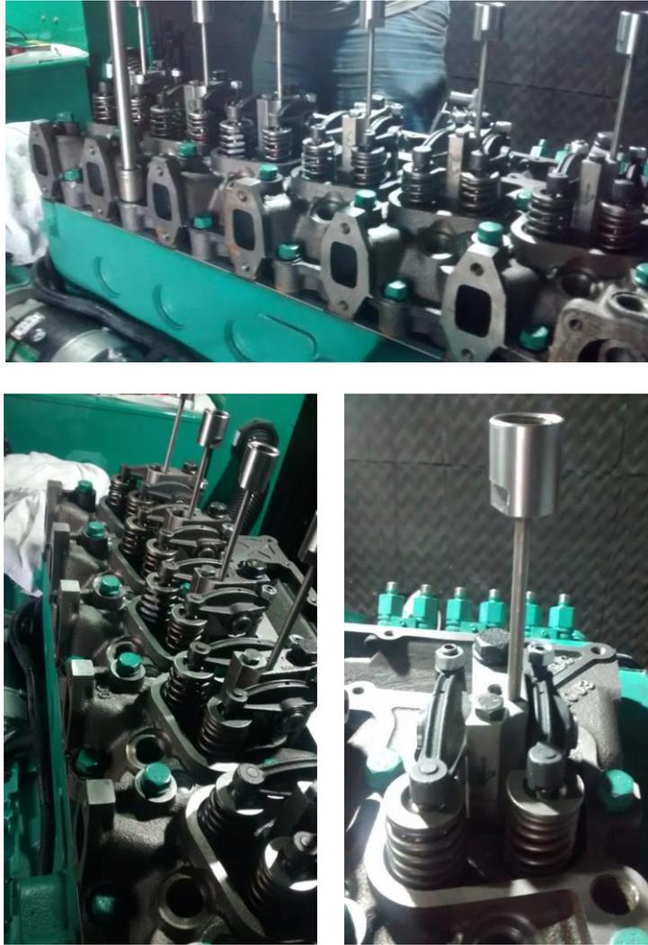
Figura 15 - Cabeçote sendo instalado junto ao motor do laboratório de modelo reduzido.
