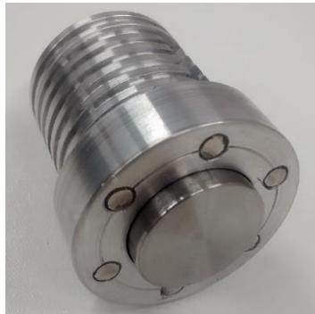
Figura 47 - Sensor de ultrassom utilizado para comparação ao sensor de posição desenvolvido para monitoramento das posições das válvulas.
