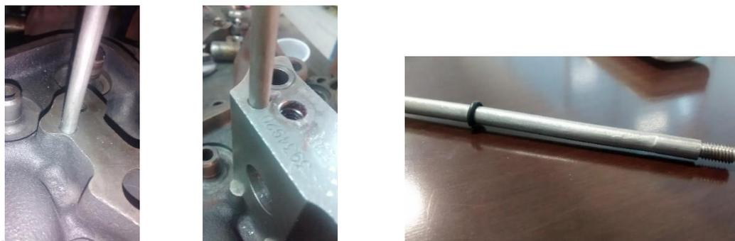
Figura 10 - Tubo de interligação entre a câmara de combustão e o lado externo do cabeçote.
