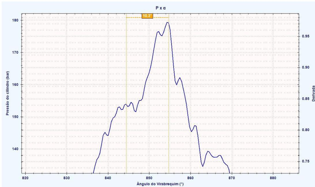
Figura 54 - Detalhe da análise de diferença angular entre a compressão e a pressão máxima.
