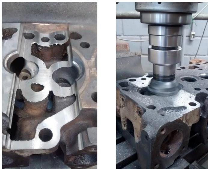
Figura 9 - Teste de avaliação das formas internas do cabeçote do motor.
