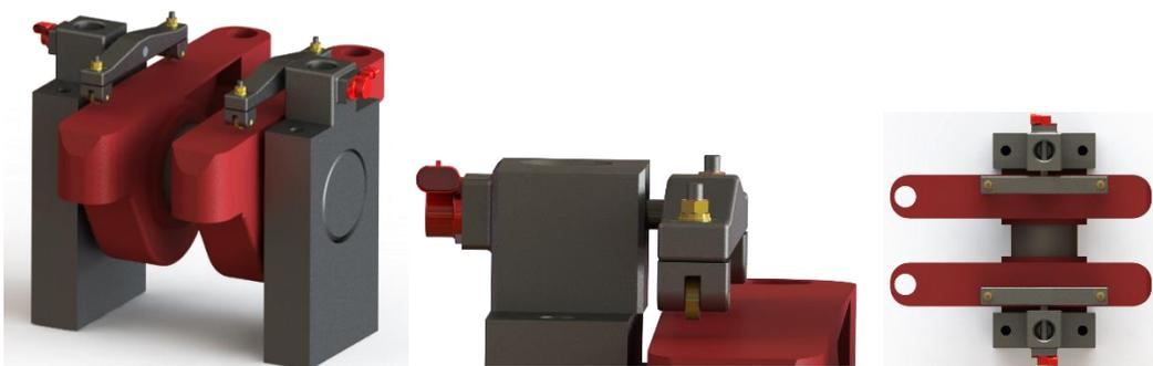
Figura 32 - Desenho do sensor de posição angular das válvulas de admissão e escape.
