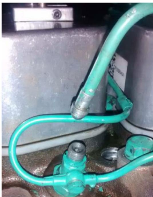
Figura 41 - Simulação para falha de injeção em um cilindro
