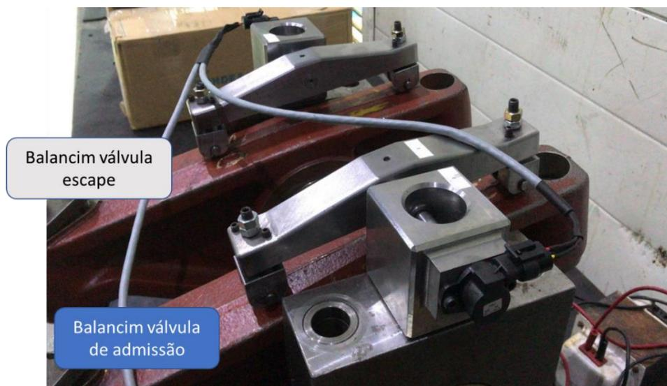
Figura 36 - Montagem dos sensores de posição das válvulas montados no laboratório de modelo reduzido.
