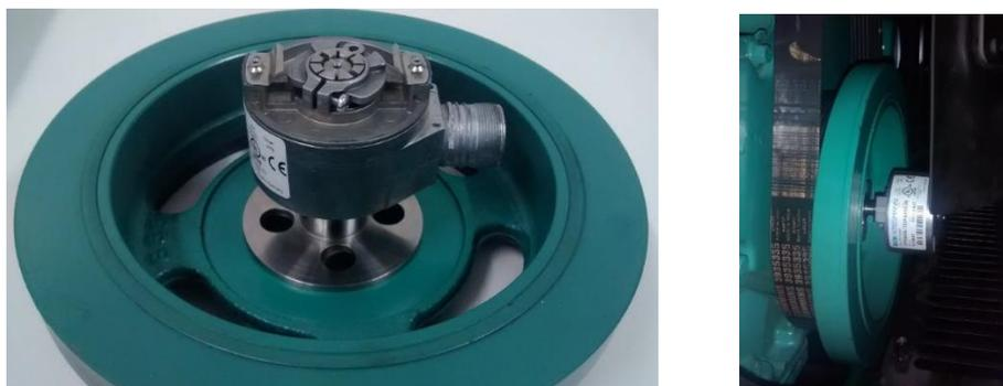
Figura 31 - Encoder instalado junto ao eixo do motor.
