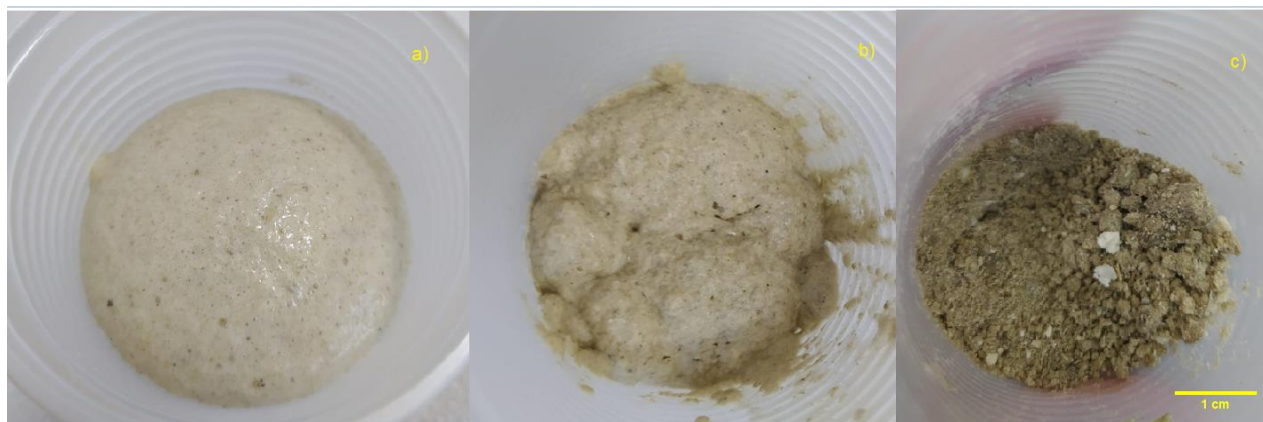
Figura 13: Testes iniciais de reação entre PUR e MDI com adição de 2 ml de água (H 2 O) após fim da reação: a)10%PUR/90%MDI + 2 ml de H 2 O, b)30%PUR/70%MDI + 2 ml de H 2 O e c)50%PUR/50%MDI + 2 ml de H 2 O Fonte: Próprio autor
