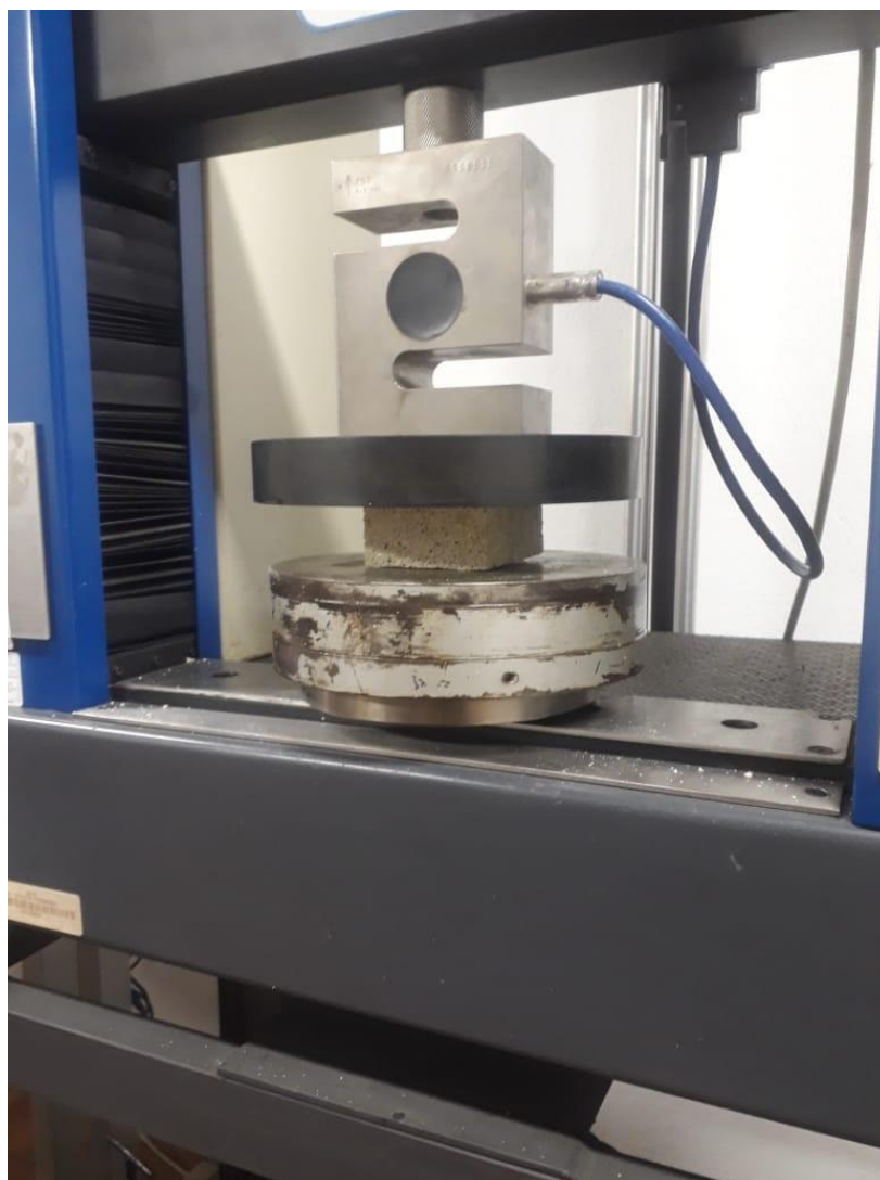
Figura 9: Ensaio de compressão de espumas rígidas de poliuretano (PUR) em máquina universal de ensaios. Fonte : Próprio autor
