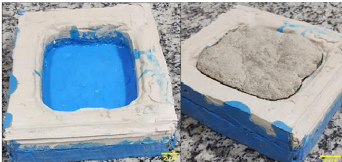
Figura 7: Síntese e espumação do PUR em molde de silicone: a) molde vazio e (b) molde com uma amostra pronta para ser desmoldada. Fonte : Próprio autor
