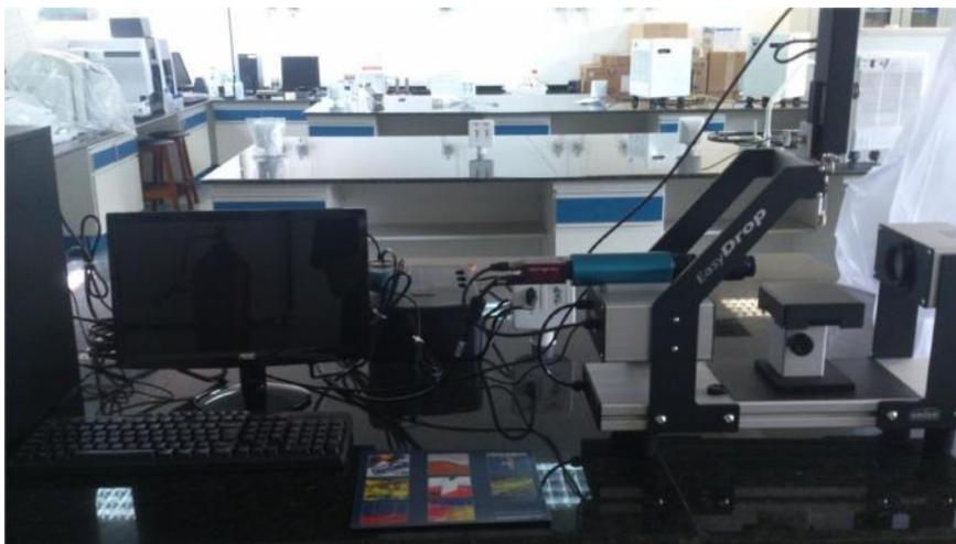
Figura 21. Sistema de medição do ângulo de contato Easy Drop da marca Kruss
