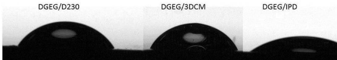
Figura 37. Variação do ângulo de contato dos sistemas DGEG/D230, DGEG/3DCM, DGEG/IPD sobre o aço inoxidável 316L silanizado
