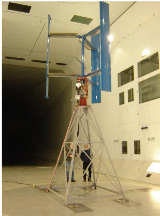
Figura 5.1 – Configuração real da turbina eólica de eixo vertical otimizada.
