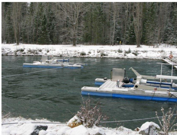
Figura 2.17: Turbinas hidrocinética com ancoragem flutuante (New Energy Corporation)
