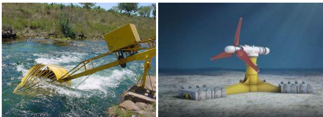
Figura 2.16: Turbinas hidrocinética com ancoragem sólida (Brasil Jr. Et al., 2007, Ibrahim et al, 2021)
