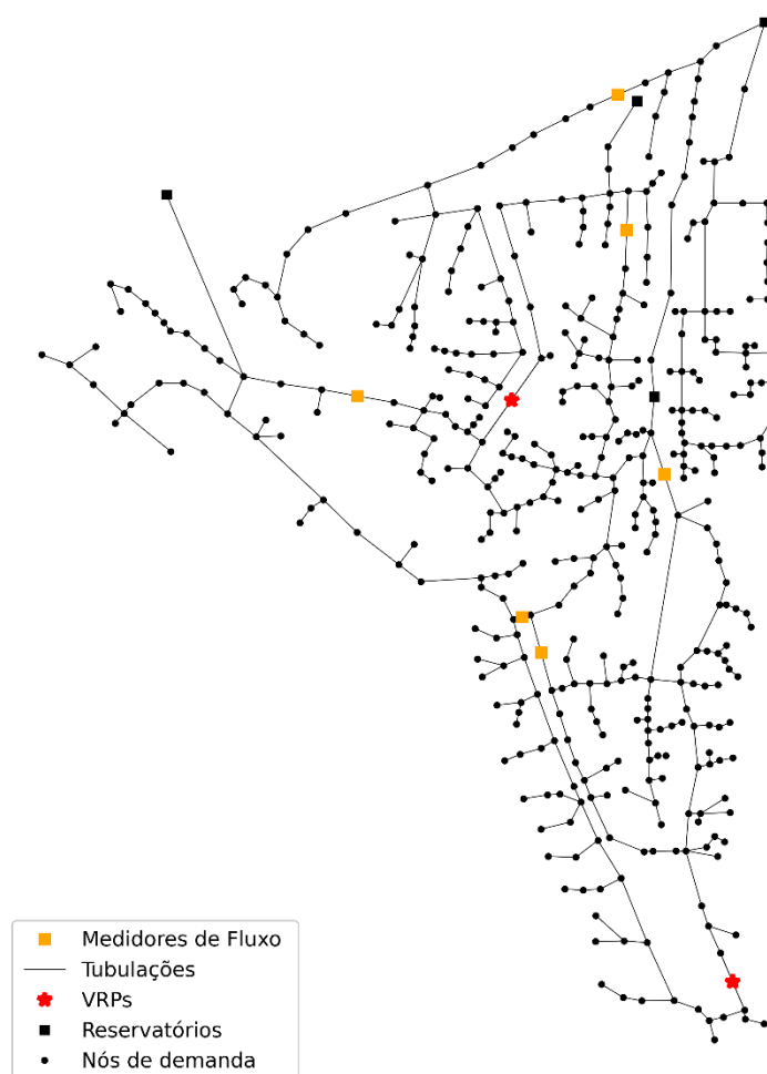
Figura 44 - Solução com 8 variáveis de decisão: instalação de 2 VRPs e 6 medidores de fluxo
