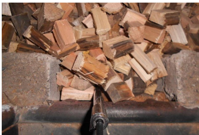
Figura 4.5. Medição da vazão do ar primário na fornalha com um anemômetro.
