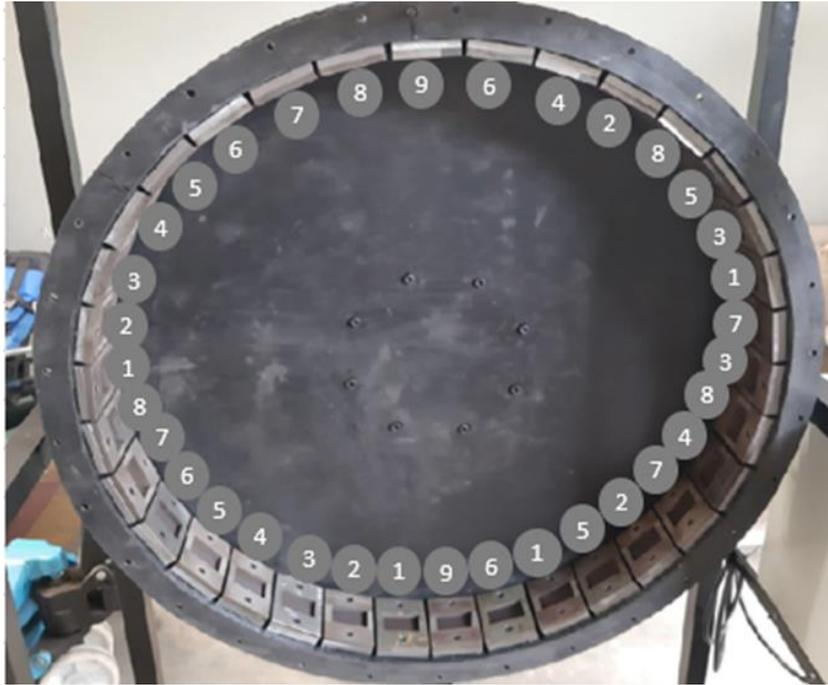
Figura 20 - Disposição das amostras dos oito tipos de materiais dentro do tambor (04 amostras de cada material)
