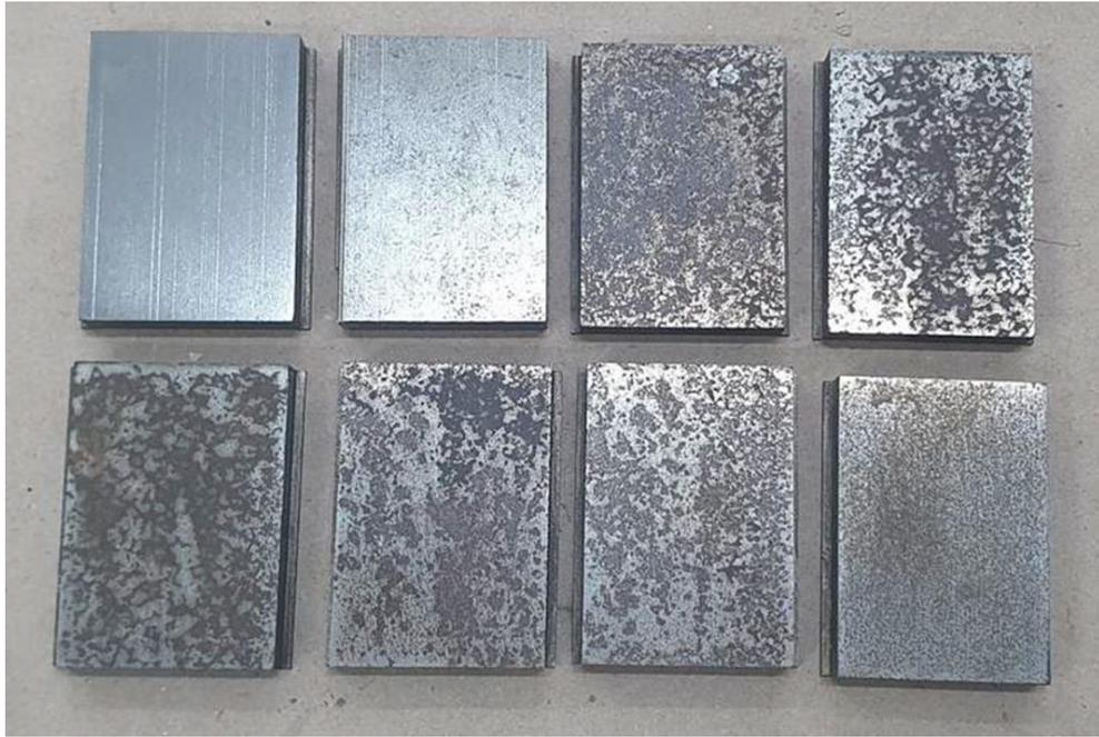
Figura 45 - Aspecto superficial das amostras após o ensaio de tamboreamento com areia
