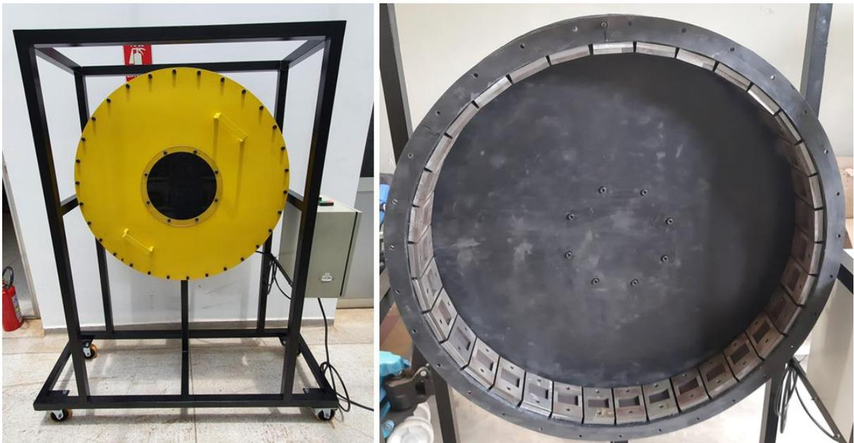
Figura 18 - Imagens da máquina de tamboreamento segundo o método SSAB
