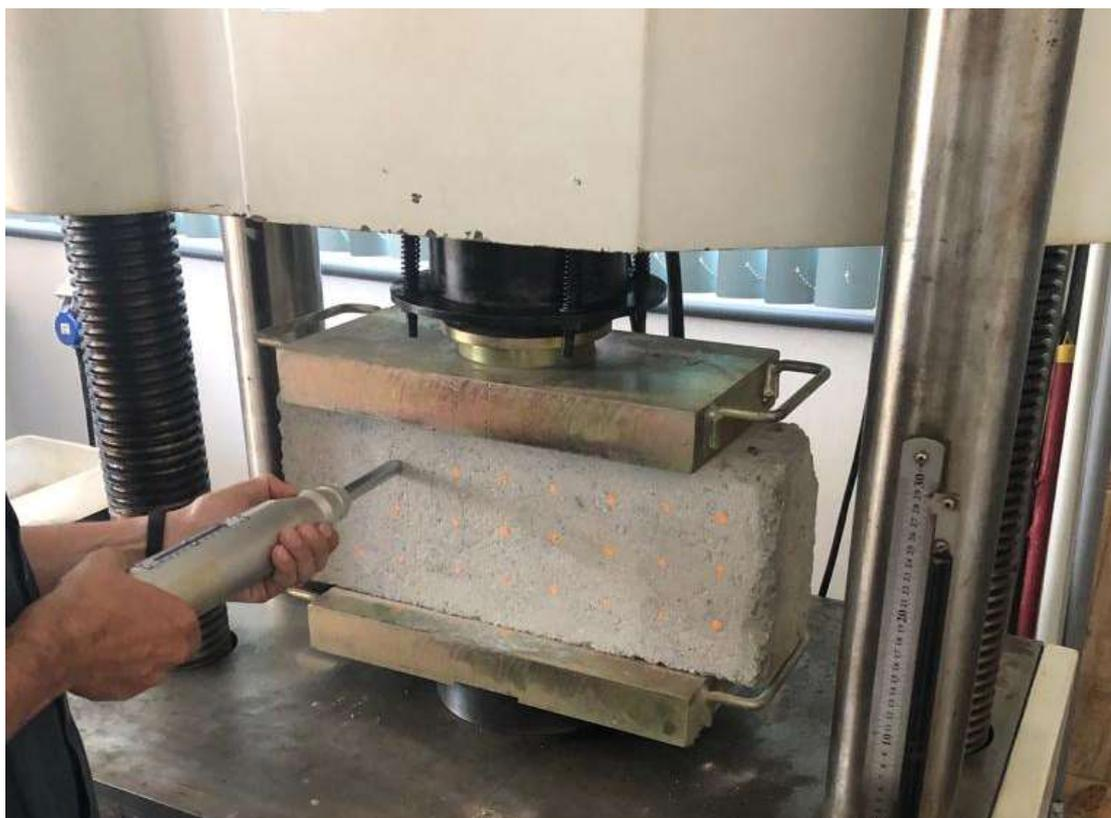
*Figura 9. Teste de esclerômetro.*
