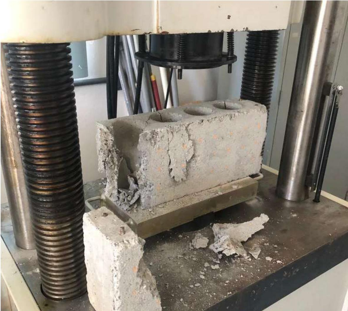
*Figura 10. Teste de compressão simples.*
