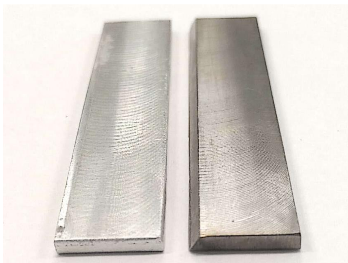
Figura 19 - Corpos de prova usinados nas dimensões a ser soldados. À esquerda CP de AA-7075-T6, à direita CP de Ti-6Al-4V.
