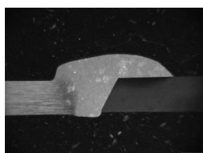
CP-18 energia de soldagem de 2,14 kJ/cm. Ataque Kroll, 30s.
