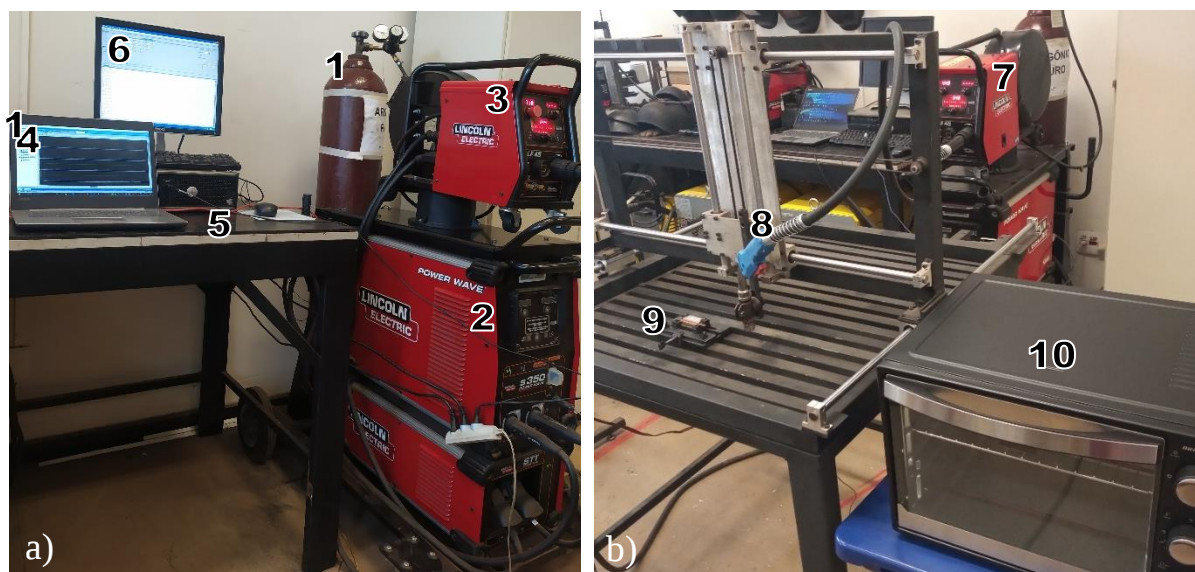
Figura 20 – a) Bancada experimental. (1) cilindro de gás, (2) fonte de soldagem, (3) cabeçote alimentador, (4) computador para aquisição dos sinais, (5) cabo de aquisição dos sinais, (6) computador para programação e controle da bancada responsável pelo deslocamento da tocha de soldagem. b) Bancada experimental controlada por computador com deslocamento em três eixos (x, y e z). (7) cabeçote deslocador da tocha de soldagem, (8) tocha de soldagem, (9) dispositivo de fixação dos Corpos de Prova, (10) Forno elétrico.
