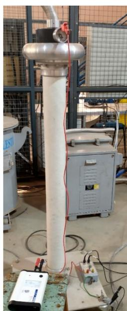
Figura 48 - Conexão do calibrador de DP ao capacitor de acoplamento do sistema *Haefely*.
