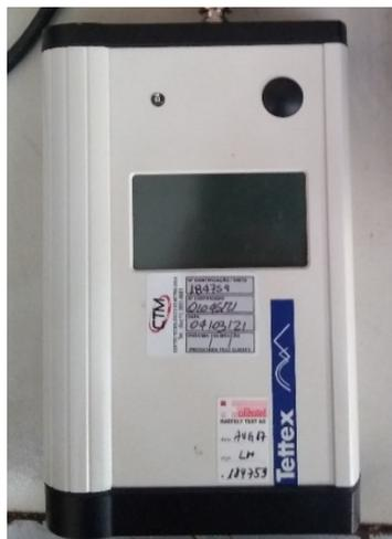
Figura 40 – Calibrador de DP do sistema *Haefely*.
