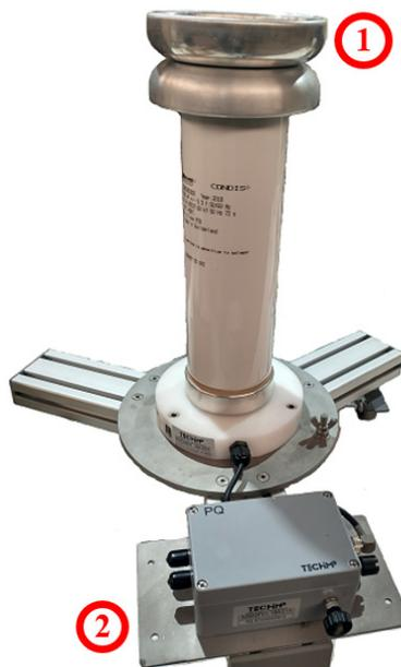
Figura 17 - (1) Capacitor de Acoplamento, (2) Quadripolo.
