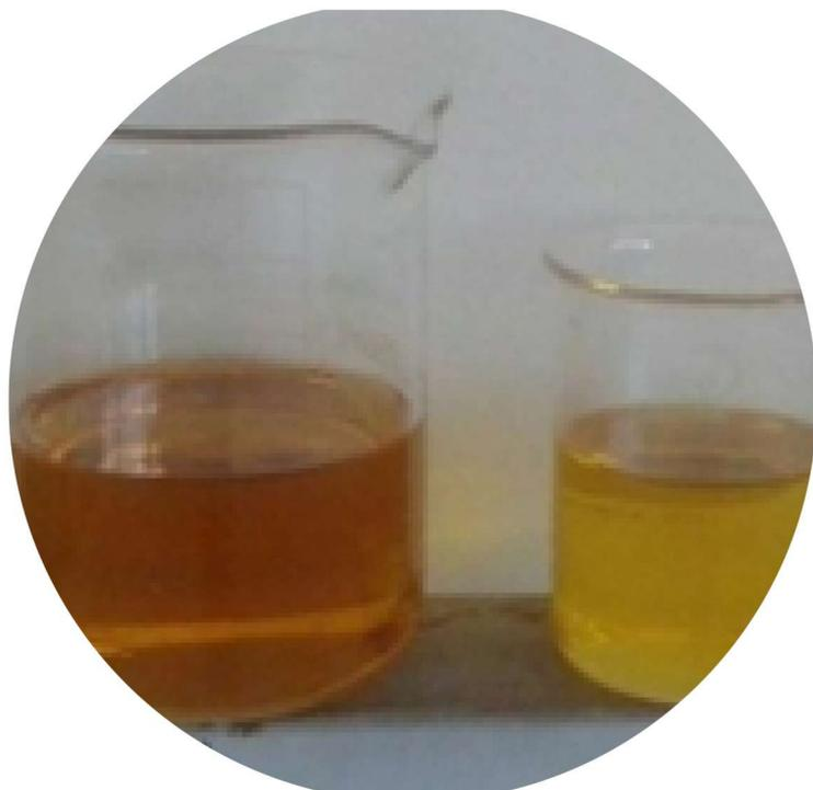
O sistema que apresentou maior capacidade de remoção foram aqueles com maior proporção de surfactante e cotensioativo. A Figura acima mostra a diferença de cor após o processo de descontaminação por microemulsão do óleo mineral de transformador. A coloração mais escura indica a presença de contaminantes, a cor mais clara revela que foi eliminado os contaminantes.
