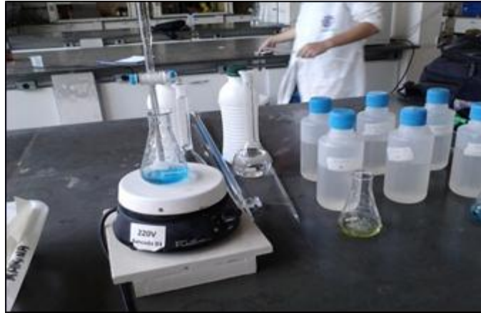
Figura 21 - Método volumétrico de neutralização para determinação de atributos químicos das amostras hídricas.
