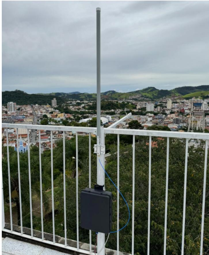
Figura 9: Instalação do *Gateway* LoRaWAN nas instalações da Rádio Panorama FM.
