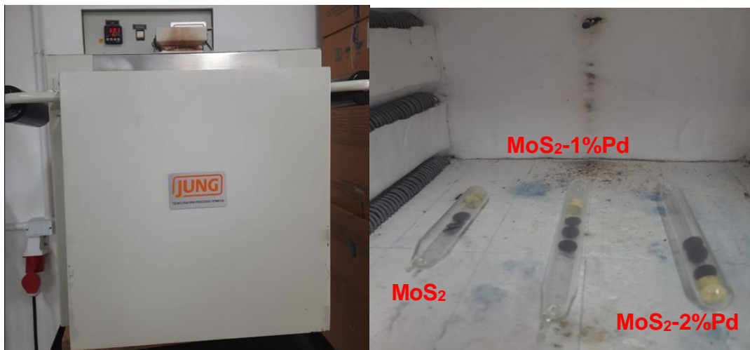
Figura 22: Forno e os tubos de vidro contendo os corpos de prova
