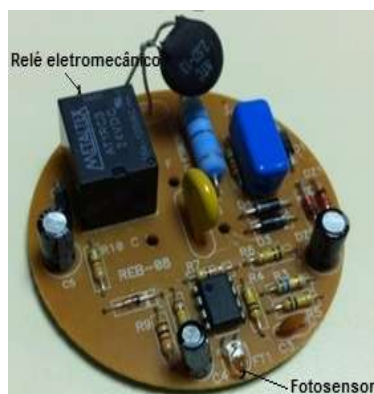
Figura 2 - relé fotocontrolador eletrônico (vista interna)
