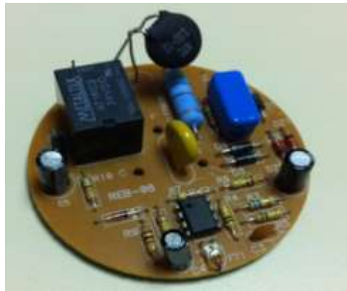
Figura 3.15 - Vista interna do relé fotocontrolador eletrônico
