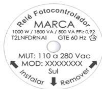
Figura 3.2 - Relé fotocontrolador azimutal: gravação da tampa
