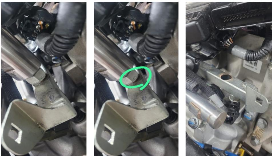
Figura 38 – Trinca detectada na flauta de gás.
