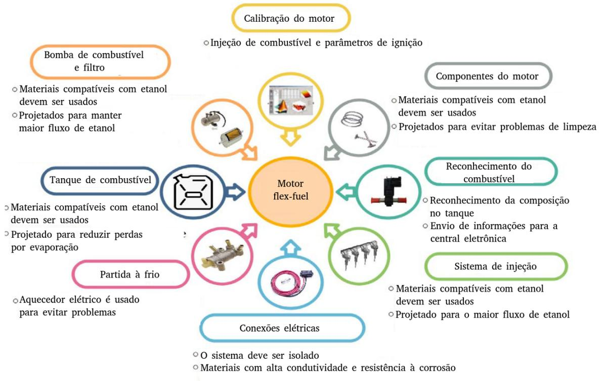
Figura 4 – Cuidados no projeto de motores *flex-fuel* com etanol e gasolina.
