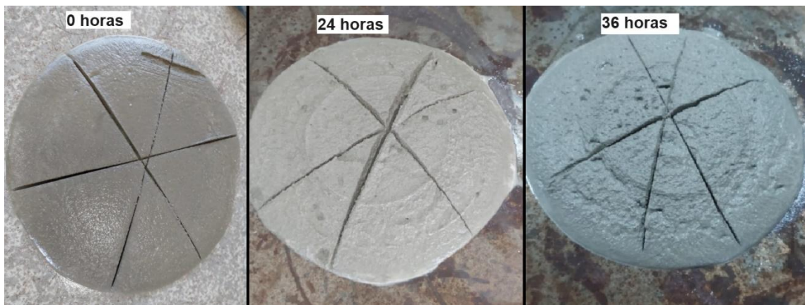
Figura 23: Mesa de consistência – Traço 0,70% Tipo 1
