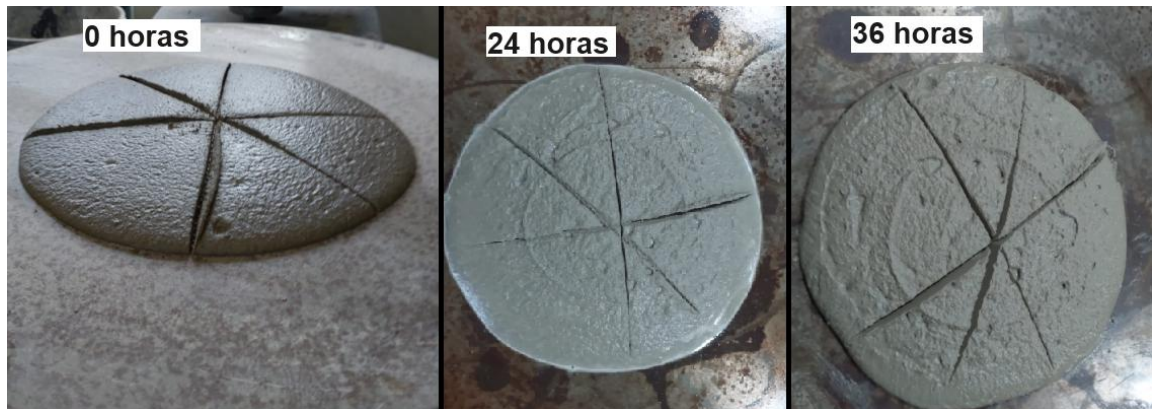
Figura 22: Mesa de consistência – Traço 0,35% Tipo 1
