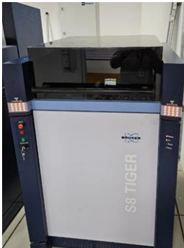
Figura 7: Equipamento S8 TIGER marca Bruker - Propriedade Supremo Secil Cimentos
