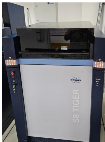
Figura 14: Equipamento S8 TIGER marca Bruker - Propriedade Supremo Secil Cimentos
