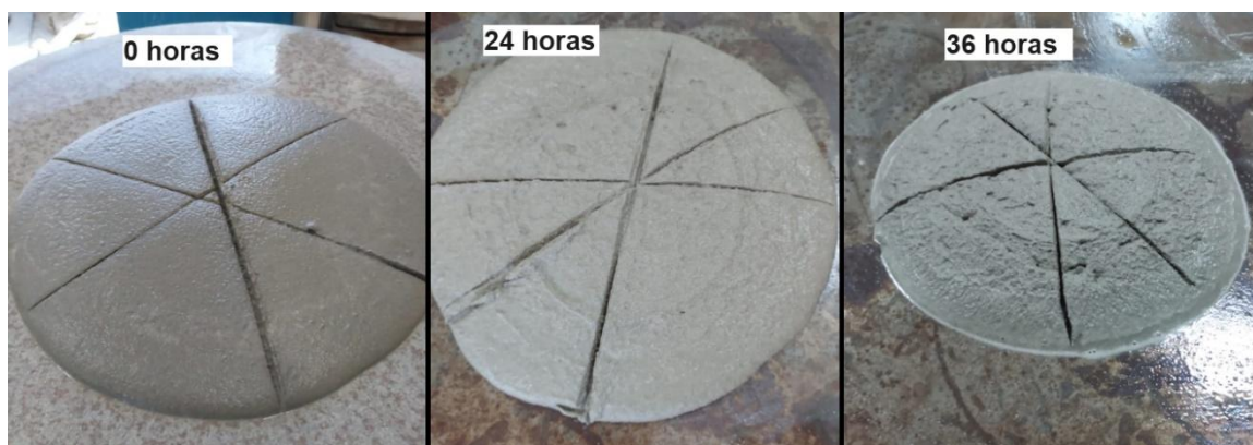
Figura 25: Mesa de consistência – Traço 0,35% Tipo 2
