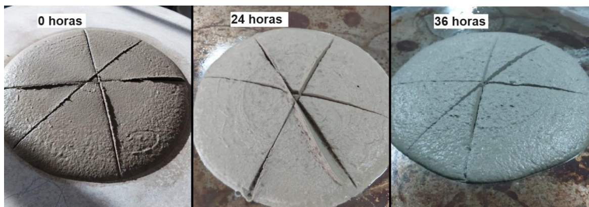
Figura 27: Mesa de consistência – Traço 1,00% Tipo 2
