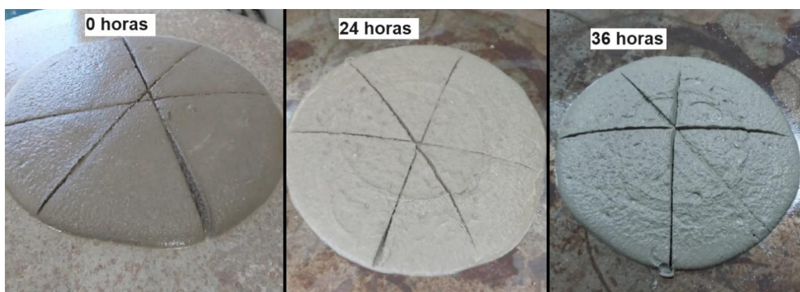
Figura 24: Mesa de consistência – Traço 1,00% Tipo 1
