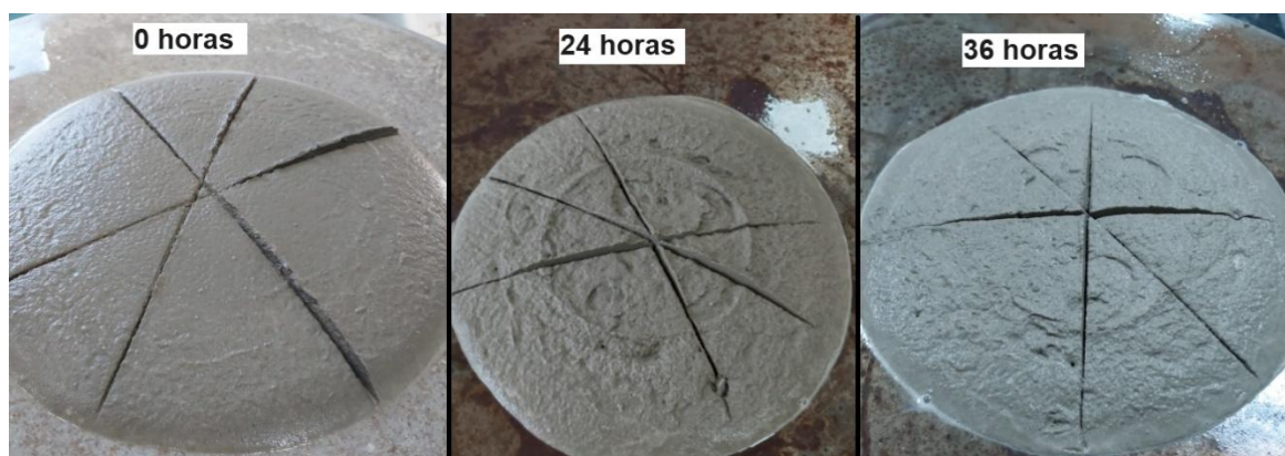
Figura 26: Mesa de consistência – Traço 0,70% Tipo 2
