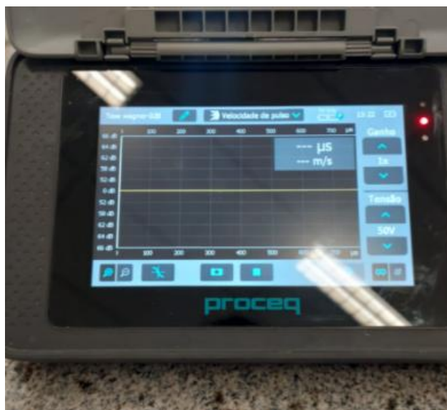
Figura 10: Aparelho de ultrassom
