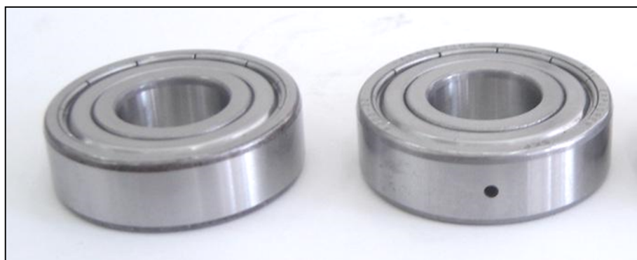
Figura 66 – Rolamentos modelo 6203-ZZ, utilizados no experimento: condição normal e furo de \phi 2,3 mm.
