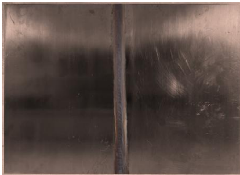
Figura 18 - Chapas de aço austenítico 316L soldadas
