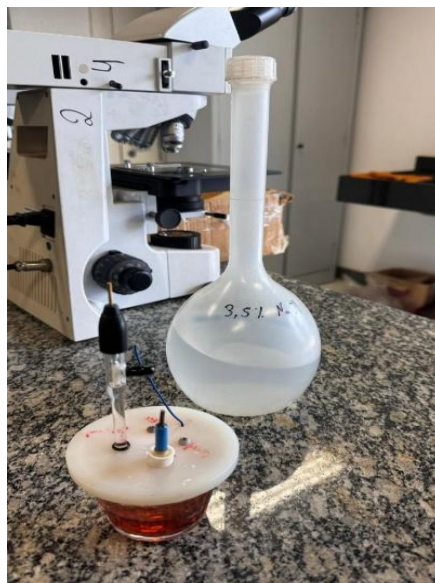
Figura 28 - Montagem para a realização do ensaio de polarização
