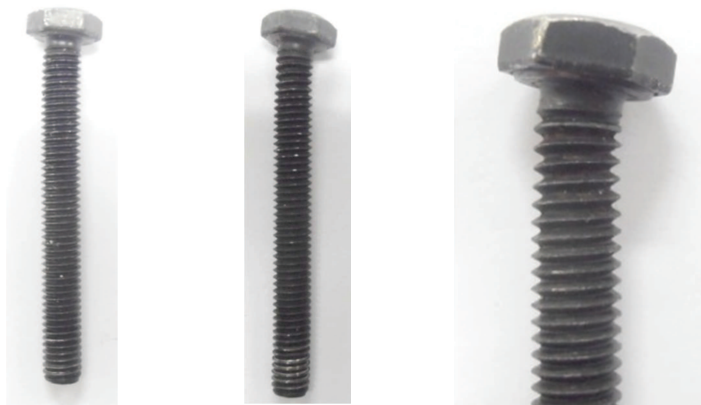
Figura 70 – Corpo de prova do segundo dispositivo para análise do empenamento.
