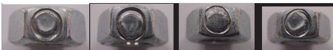
Figura 72 – (1) Puncionamento da porca, restrição de movimento e demais deslocamentos do punção em relação ao empenamento.
