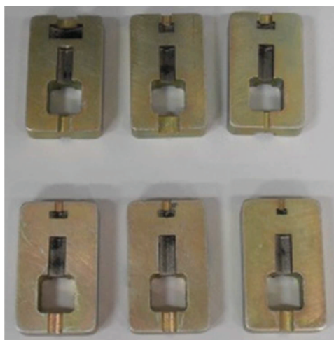
Figura 27 – Insertos intercambiáveis conjunto para diâmetros de 2 a 5 milímetros.
