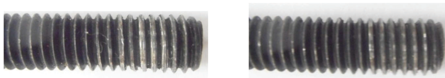
Figura 71 – Deformidade da rosca ao empenamento livre.
