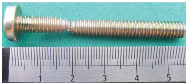
Figura 50 – Falha de ruptura na rosca do elemento classe 4.8 ensaiado.
