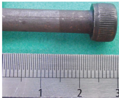
Figura 67 – Empenamento com restrição de movimento da cabeça do elemento.
