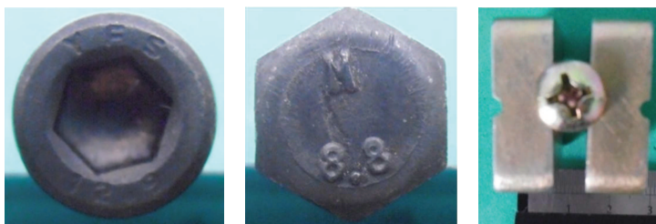
Figura 40 – Formato da cabeça dos elementos de fixação formadores dos grupos de cpd para ensaio (a) Allen, M6x75, (b) Sextavado, M6x75 e (c) Philips, M6x75.
