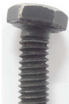
Figura 46 – Último filete de rosca próximo à cabeça do parafuso.
