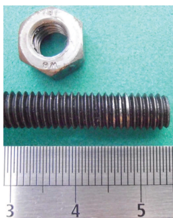
Figura 75 – Deformação da rosca na zona de plasticidade.
