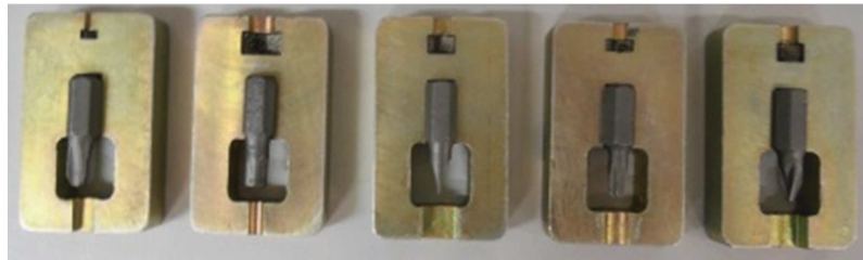
Figura 33 – Montagem da ponta individual de aperto sobre o inserto intercambiável.
