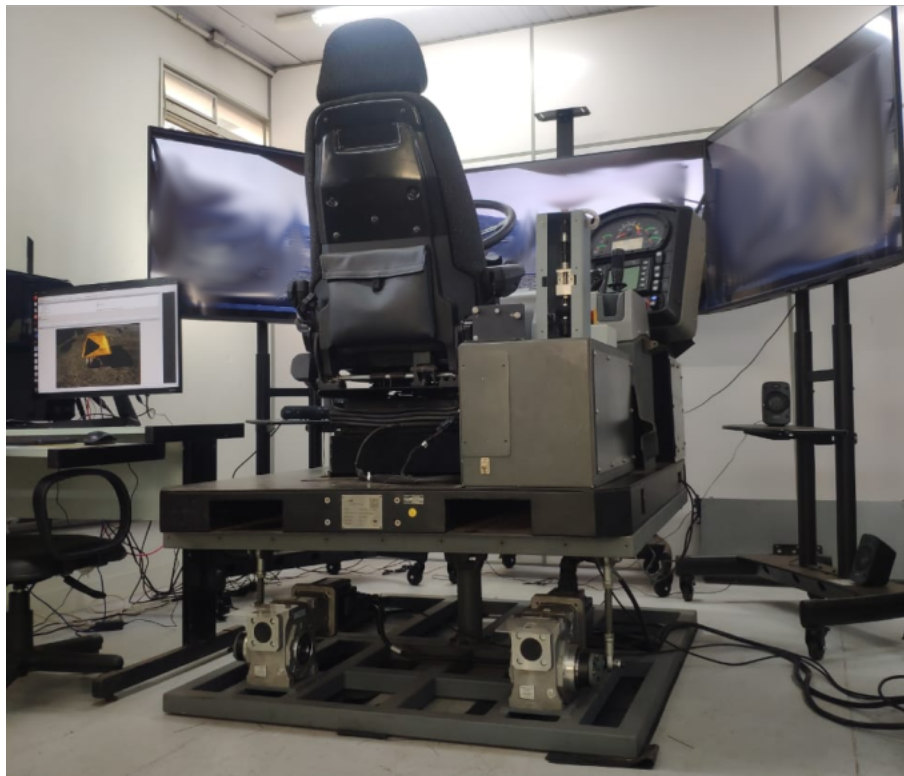
Figura 2 – Simulador do caminhão fora de estrada CAT793F.
