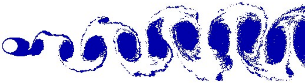
Figura 5.13 – Estrutura da esteira de vórtices para o tempo final t = 100 para o cilindro circular liso oscilando in-line com frequência de oscilação forçada de f_0 = 0,04 ( M = 300 , \Delta t = 0,05 , \sigma_0 = 0,001 , Re = 10^5 , f_0 = 0,04 e A = 0,13 ).
