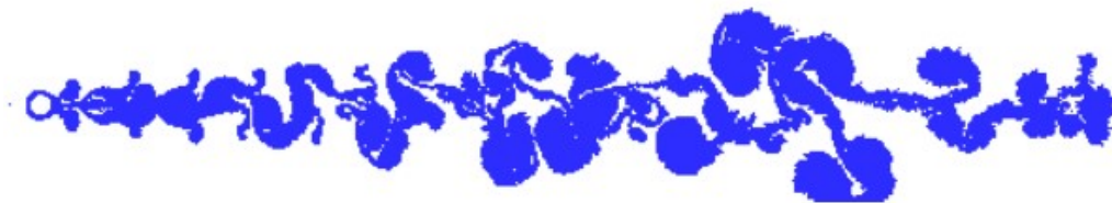
Figura 2.17 – Modo simétrico da estrutura de vórtices na esteira do cilindro circular oscilando in-line com Re = 10^5 . (Reproduzida de Silva Siqueira [12]).
