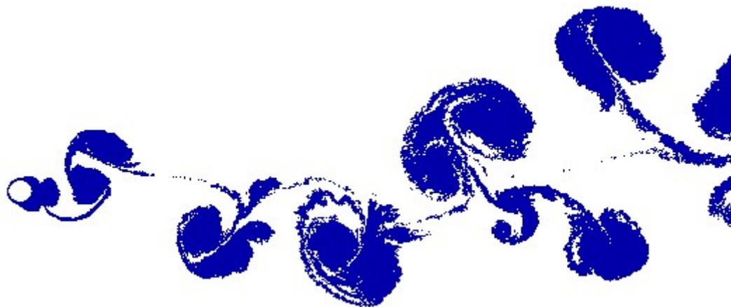
Figura 5.25 – Estrutura da esteira de vórtices para o tempo final t = 75 para o cilindro circular rugoso ( \varepsilon/D = 0,007 ) oscilando in-line com frequência de oscilação forçada de f_0 = 0,2 ( M = 300 , \Delta t = 0,05 , \sigma_0 = 0,001 , Re = 10^5 e A = 0,13 ).
