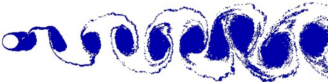
Figura 5.10 – Estrutura da esteira de vórtices para o tempo final t = 50 para o cilindro circular estacionário ( M = 300 , \Delta t = 0,05 , \sigma_0 = 0,001 , Re = 10^5 ).
