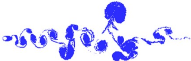
Figura 2.20 – Competição entre o modo antissimétrico A-I e A-III da estrutura de vórtices na esteira do cilindro circular oscilando in-line com Re = 10^5 . (Reproduzida de Silva Siqueira [12]).
