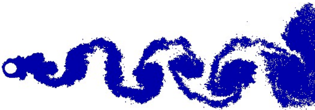
Figura 5.39 – Estrutura da esteira de vórtices para o tempo final t = 50 para o cilindro circular rugoso ( \varepsilon/D = 0,0045 ) oscilando in-line com frequência de oscilação forçada de f_0 = 0,8 ( M = 300 , \Delta t = 0,05 , \sigma_0 = 0,001 , Re = 10^5 e A = 0,13 ).
