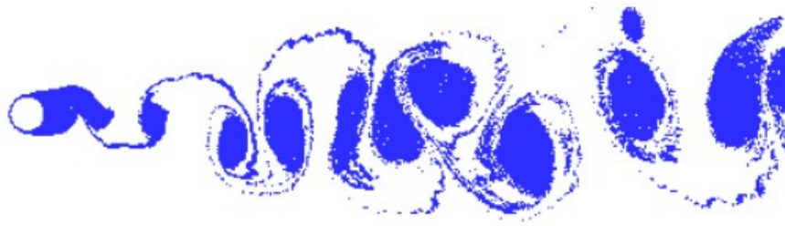
Figura 2.18 – Modo antissimétrico A-I da estrutura de vórtices na esteira do cilindro circular oscilando in-line com Re = 10^5 . (Reproduzida de Silva Siqueira [12]).
