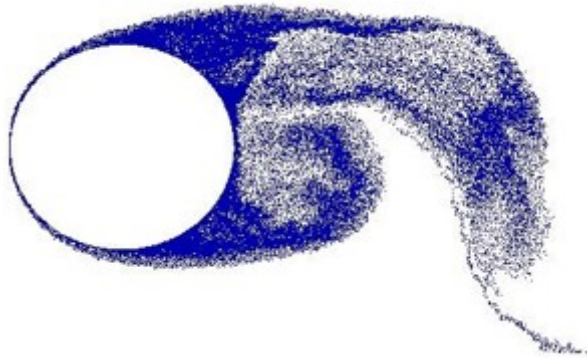
Figura 5.7 – Desprendimento de uma estrutura vorticosa anti-horária no instante de tempo t = 38,95 (Ponto R).
