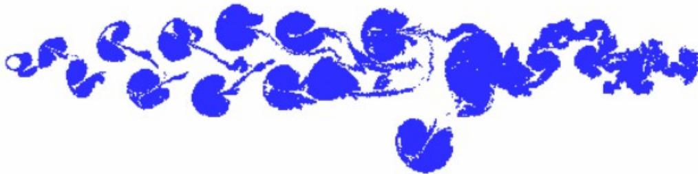
Figura 2.19 – Modo antissimétrico A-IV da estrutura de vórtices na esteira do cilindro circular oscilando in-line com Re = 10^5 . (Reproduzida de Silva Siqueira [12]).
