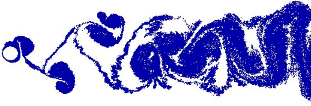
Figura 5.30 – Estrutura da esteira de vórtices para o tempo final t = 50 para o cilindro circular rugoso \varepsilon/D = 0,007 oscilando in-line com frequência de oscilação forçada de f_0 = 0,34 ( M = 300, \Delta t = 0,05, \sigma_0 = 0,001, Re = 10^5 e A = 0,13 ).
