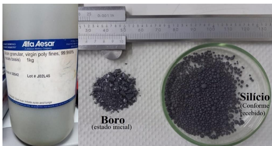
Figura 10. Boro e Silício, no estado inicial, antes da moagem
