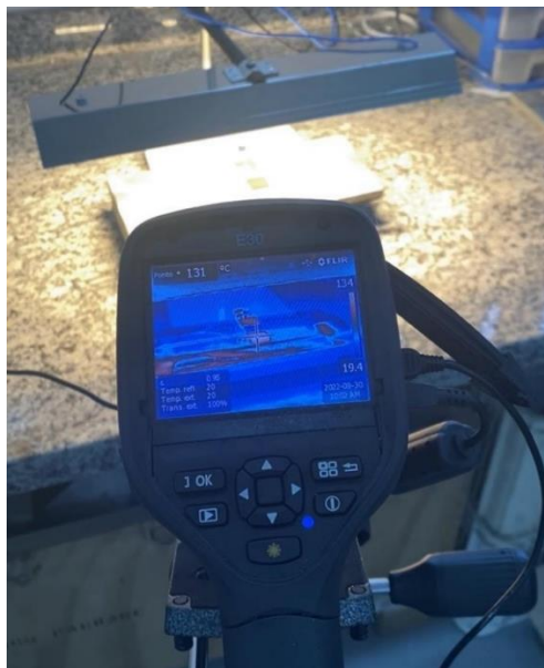
Figura 25: Imagens térmicas coletadas durante o aquecimento utilizando a fonte de luz infravermelha de amostra de material compósito Elium®150 e reforço de fibra de carbono.
