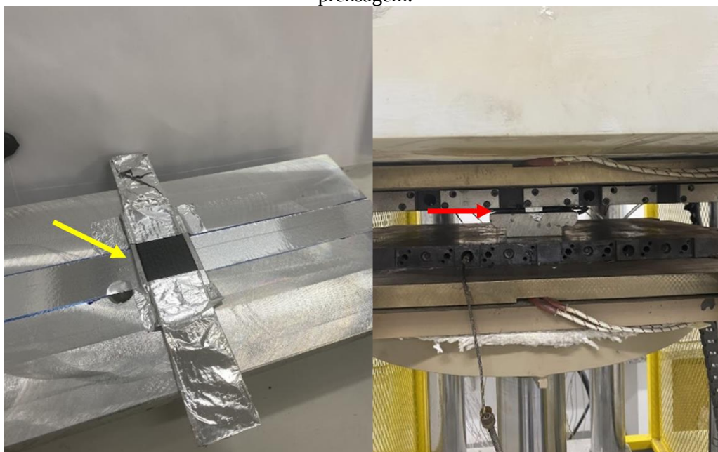
Figura 24: Imagem de a) calços antiesmagamento e b) gap proporcionado durante a etapa de prensagem.
