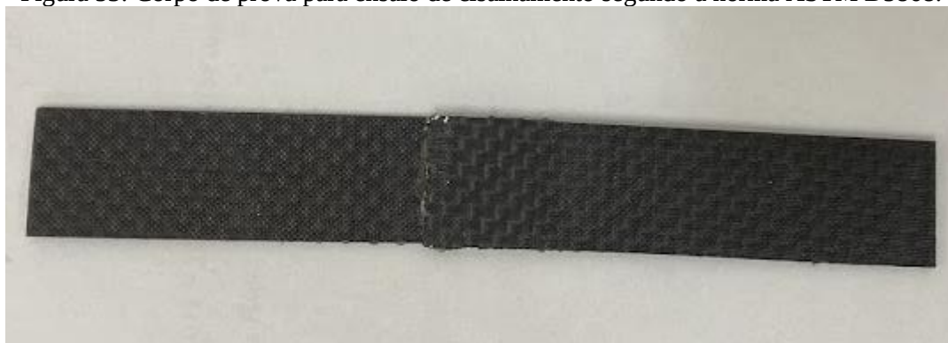
Figura 53: Corpo de prova para ensaio de cisalhamento segundo a norma ASTM D5868.
