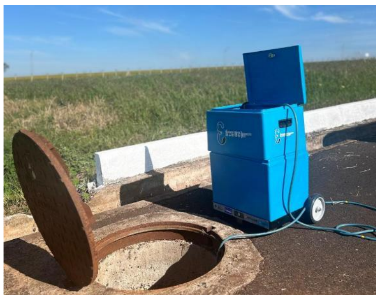
Figura 23 - Amostrador automático Étsus 2000
