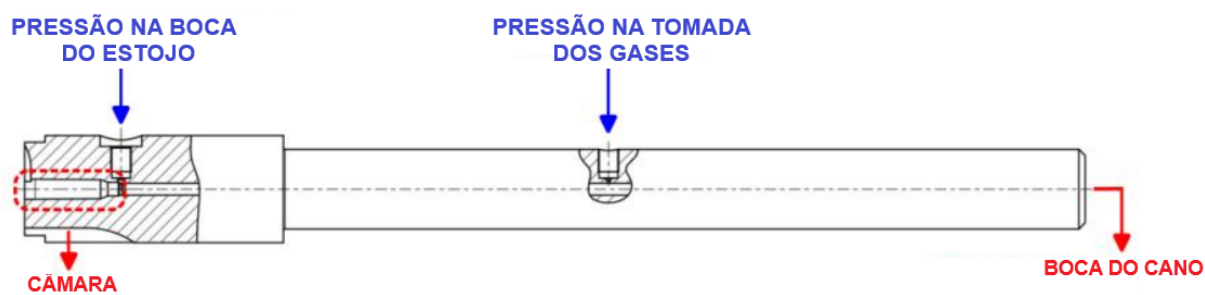
Figura 3.2 – Posição dos transdutores para o ensaio balístico. Adaptado de Felix, Medeiros e Barbosa (2023).
