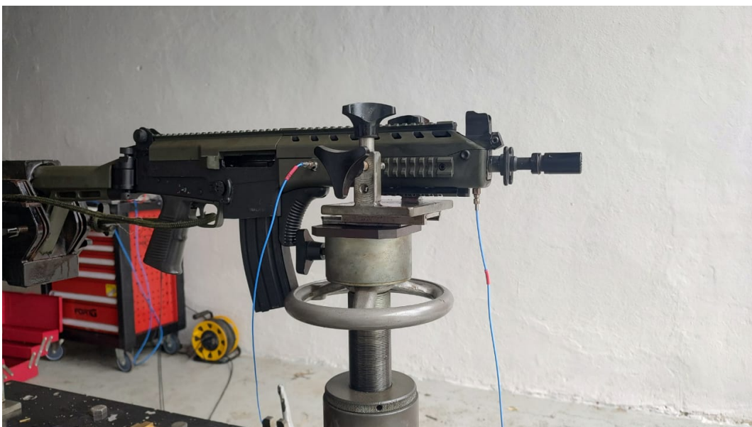
Figura 3.1 – Instrumentação do armamento com sensores de pressão.
