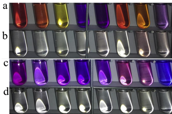
Figura 1.2: Soluções do complexo CoMC: a) antes e b) após a exposição à radiação visível, e do ligante espiro c) após a radiação UV e d) após a radiação visível. Ordem dos solventes para as figuras a e b: metanol, isopropanol, etanol, acetonitrila, DMSO, DMF, acetona, 2 -butanona e THF (da esquerda para a direita), ordem dos solventes das Figuras c e d: como etanol, acetonitrila, DMSO, DMF, acetona, diclorometano, clorofórmio e THF (da esquerda para a direita). Permissão de utilização da editora Elsevier, order number: 5931010002295 (MIGUEZ et al., 2019).
