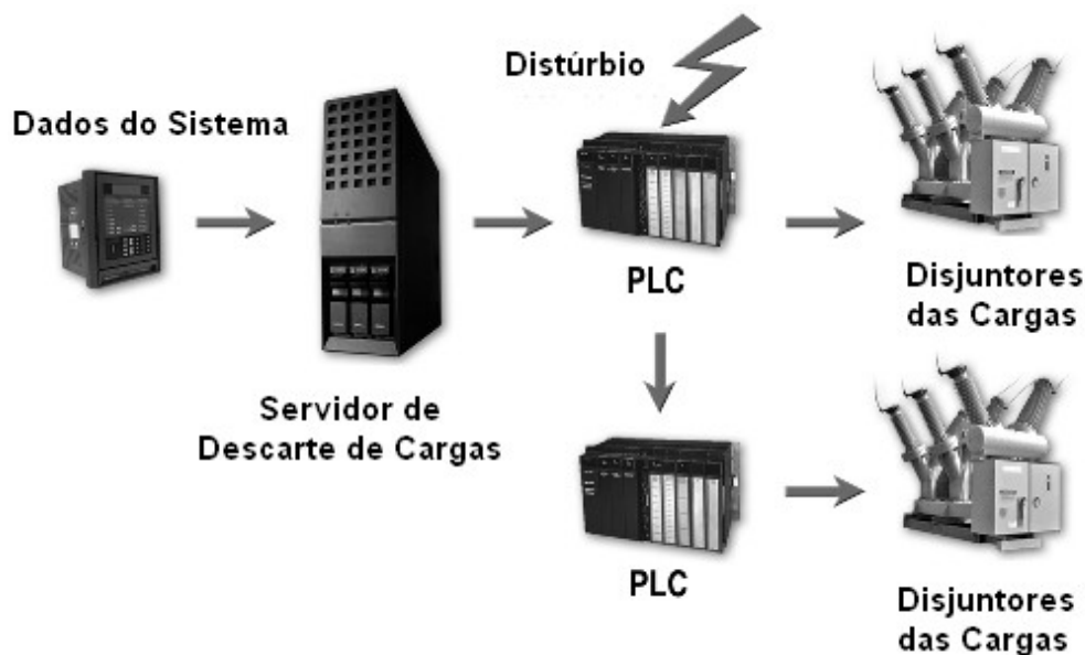
Figura 4.4 - Diagrama Simplificado do Hardware de um Sistema de Alívio de Cargas Inteligente
