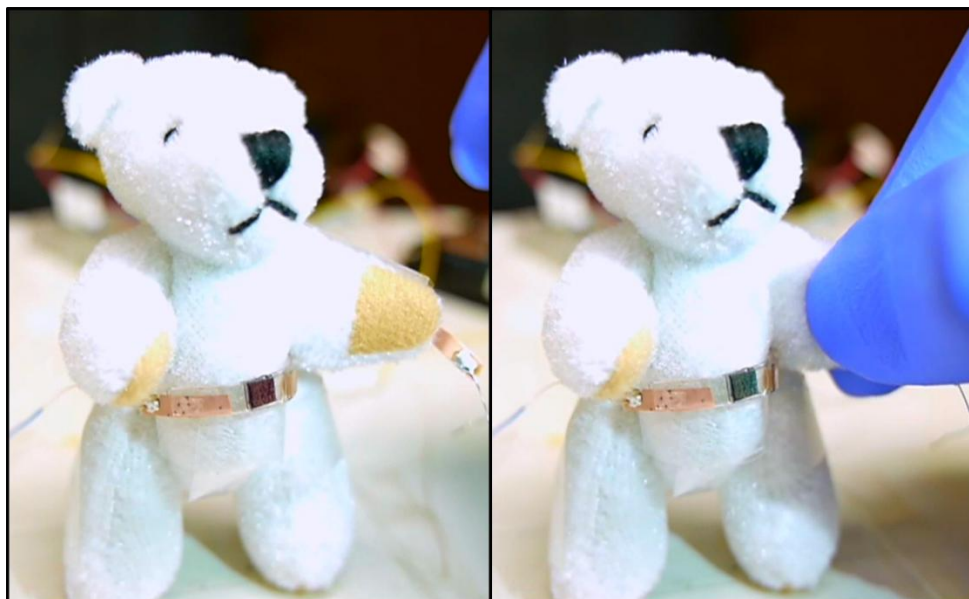
Figura 1.1: Ilustração da aplicação da pele responsiva como sensor elétrico de toque. Adaptado de: (CHOU et al. , 2015)
