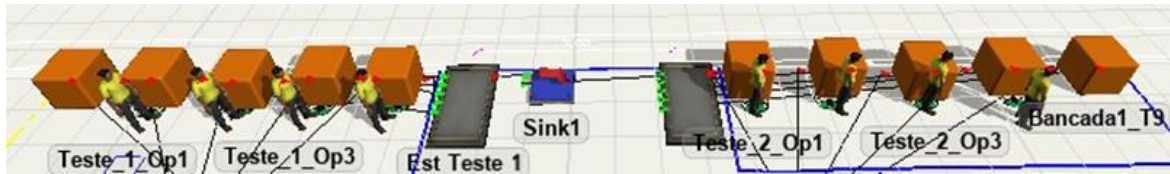
Figura 18 – Configuração da linha de produção após a adição de um posto de trabalho no FlexSim®. Fonte: Própria, autor.
